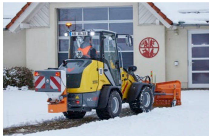
Manutenzione stradale invernale semplificata con lama spazzaneve e spargisale.
