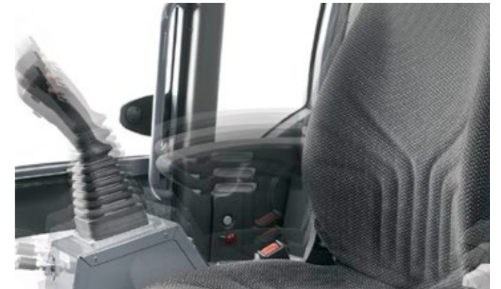
Consolle con joystick regolabile e oscillante sul sedile dell'operatore.
