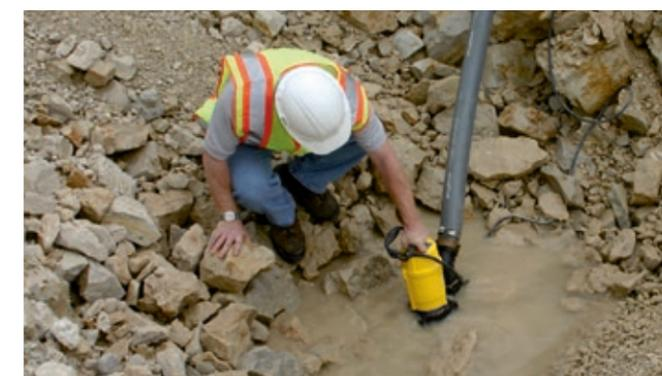
**Bombas sumergibles eléctricas con protección contra marcha en seco:** incluso en caso de marcha intermitente por falta de agua gracias al distribuidor de aceite integrado.
