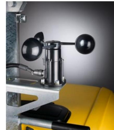
El sensor de viento baja automáticamente el mástil en caso de fuerte viento. (LTN5)
