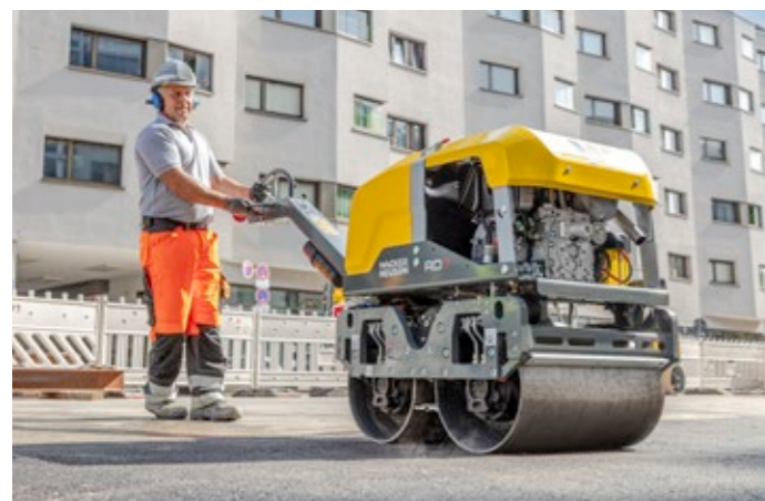
Langt styrehåndtak forenkler styring og svingning, spesielt på små flater.
