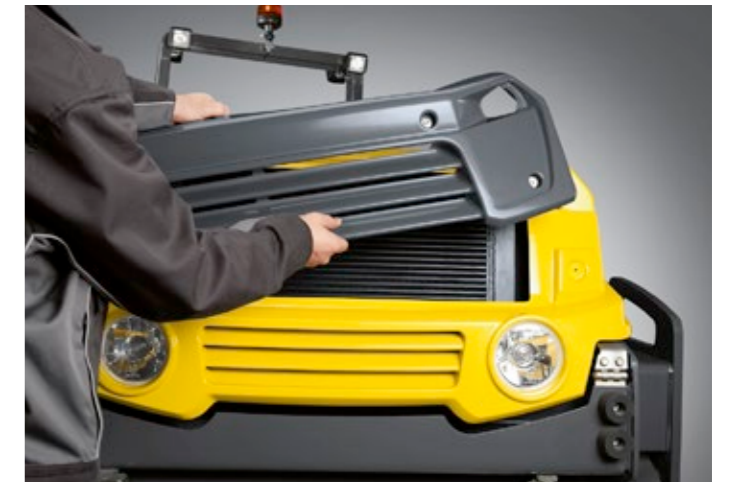
Enkel radiatorrengjøring: med separat avtakbar klaff på motordekselet.
