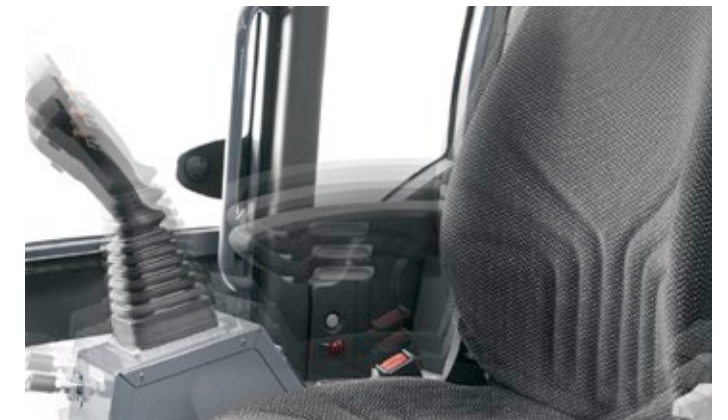
Justerbar joystick-konsol på förarens säte som svänger med.
