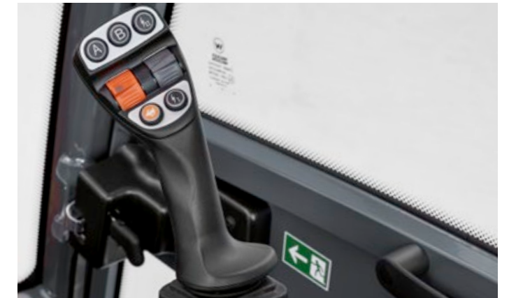
Förarvänlig och multifunktionell: den innovativa joysticken med ergonomisk, upplyst touch-styrning.
