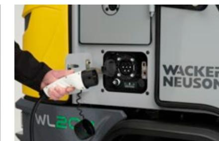
2. Ouvrir le volet d'entretien, brancher la prise de Type 2 sur la machine.
