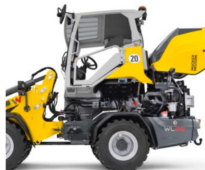
WL20, WL25 et WL28 sont aménagées d'un poste de conduite inclinable ou d'une cabine rabattable. Ceci permet un accès facile au moteur, au système hydraulique et à l'électronique. Le capot-moteur peut être ouvert en grand, offrant ainsi une accessibilité optimale.
