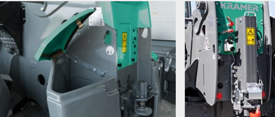
Отделение для хранения принадлежностей в задних противовесах для КТ457 – КТ559
