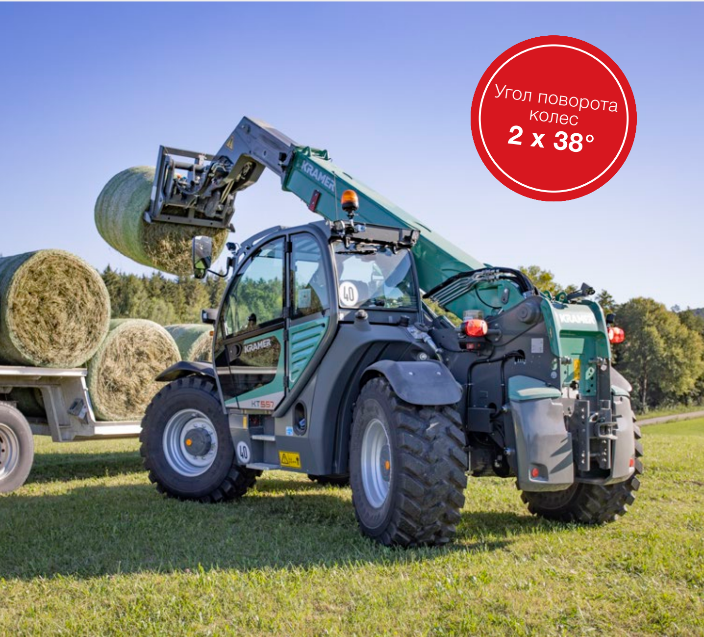
Подруливание всеми колесами для максимальной маневренности
