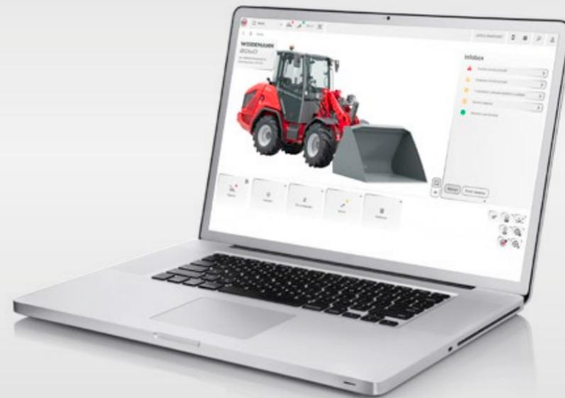
Les systèmes de diagnostic et d'analyse Weidemann wedias ou Equip Inspector permettent d'évaluer rapidement et clairement de nombreuses fonctions, notamment la fonction de conduite, les 3e et 4e circuits de commande, les données du moteur ainsi que les fonctions électriques. Les messages d'erreurs sur l'écran signalent immédiatement à l'opérateur les éventuels dysfonctionnements et permettent de réagir rapidement.
