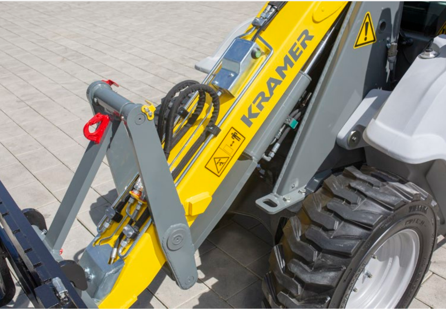
Solidny wysięgnik z kinematyką Z, wizualnym wskaźnikiem pozycji i opcjonalnym hakiem ładunkowym.
