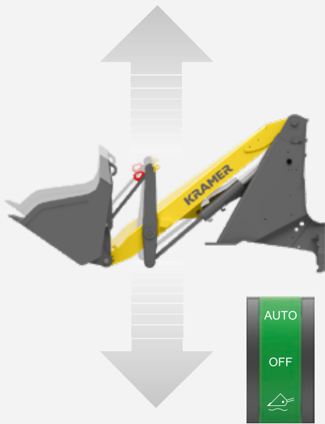
Automatyczny stabilizator obciążenia zapobiega kołysaniu się maszyny i ogranicza straty materiału.
