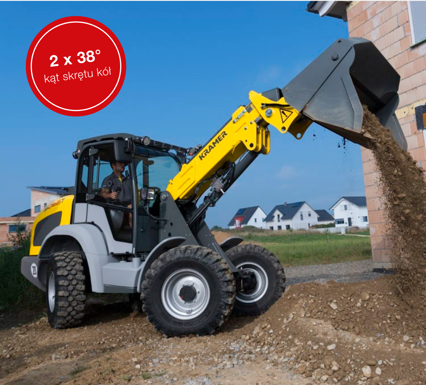
Tryb kierowania na wszystkie koła: szczególna zwrotność na ograniczonej przestrzeni
