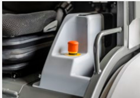
Szybko dostępny wyłącznik awaryjny, aby w razie zagrożenia maszyną można było niezwłocznie przestawić w bezpieczny stan.
