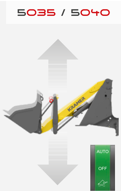
Automatický stabilizátor nákladu zabraňuje kývání stroje a snižuje ztráty materiálu.
