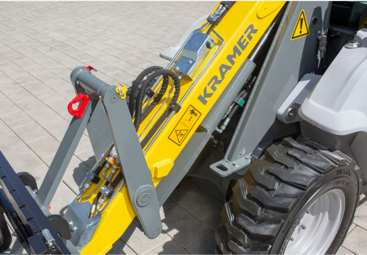
Robustní výložník se Z-kinematikou, vizuálním ukazatelem pozice a volitelným závěsným hákem.
