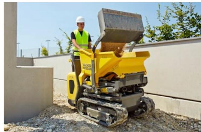
Benne à déversement haut avec système d'auto-chargement (SLE)
