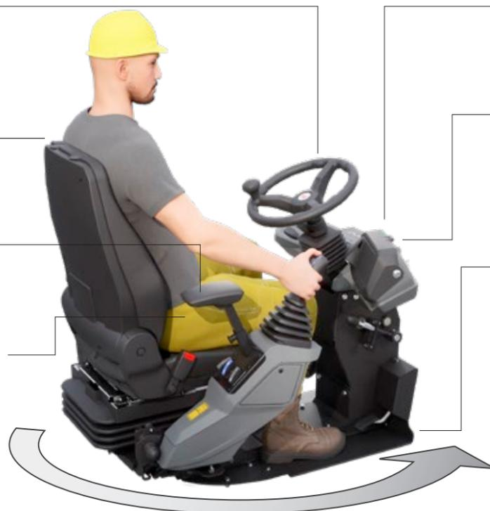
Display multifunzione per le funzioni della macchina, incl. protezione del display bloccabile
