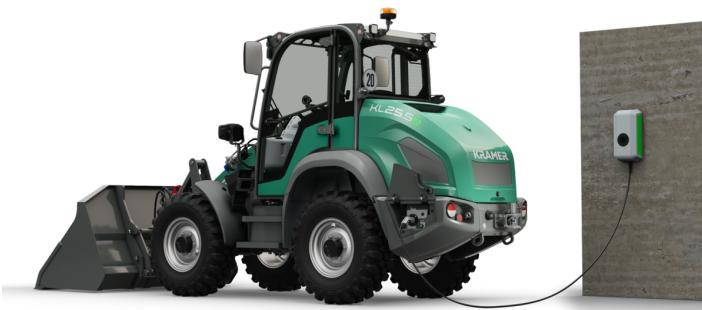
**Зарядка:** интегрированное бортовое зарядное устройство мощностью до 9 кВт обеспечивает быструю зарядку
