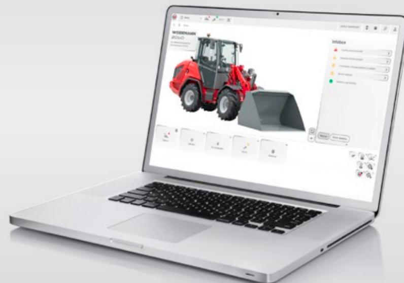
Mit Hilfe der Weidemann Diagnose- und Analysensysteme wedias bzw. Equip Inspector sind viele Funktionen, u. a. die Fahrfunktion, der 3. und 4. Steuerkreis, die Motordaten sowie die Elektrofunktionen, schnell und eindeutig auswertbar. Fehlermeldungen im Display machen den Fahrer sofort auf mögliche Fehler aufmerksam und ein schnelles Reagieren möglich.
