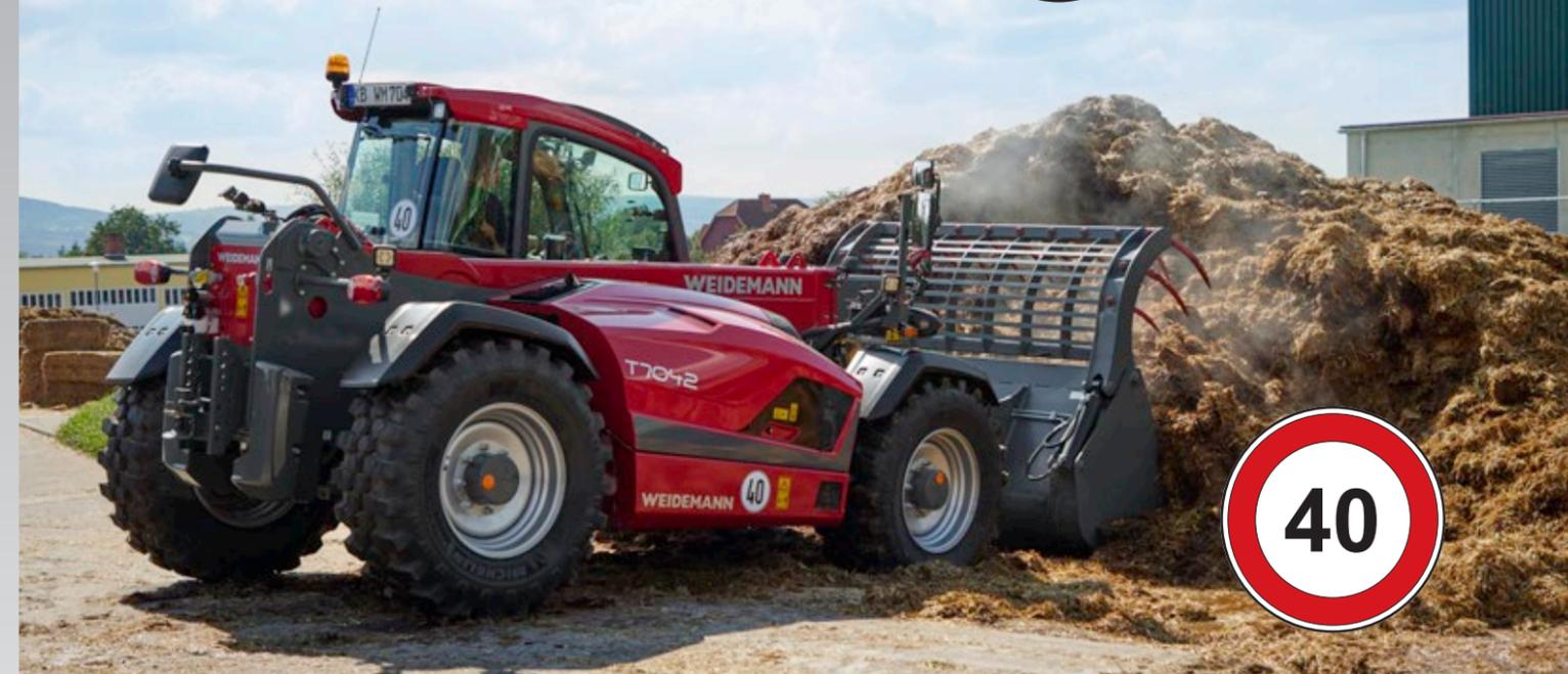
• Der Fahrtrieb Power Drive ist ein stufenloses hydrostatisches Getriebe, welches höhere Zugkräfte und Fahrgeschwindigkeiten erreicht als bisher entwickelte Lösungen. Dies erfolgt unter Beibehaltung aller Vorteile bisheriger Fahrtriebe in Bezug auf Kompaktheit, Energieeffizienz und Bedienerkomfort.
