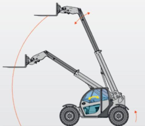
**Mit vls.** Nahezu vertikale Bewegung. Kaum Lastmomentverlagerung in Längsrichtung der Maschine.
