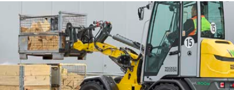
WL300e: den lave forvognen som fås som ekstrautstyr, kombinert med en kort lastearm, gir ypperlig oversikt og en betydelig bedre tipplast.
