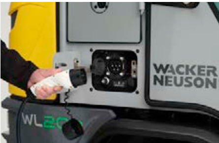
2. Åpne lasteklappen, sett inn type 2-ladestøpsel på maskinsiden.
