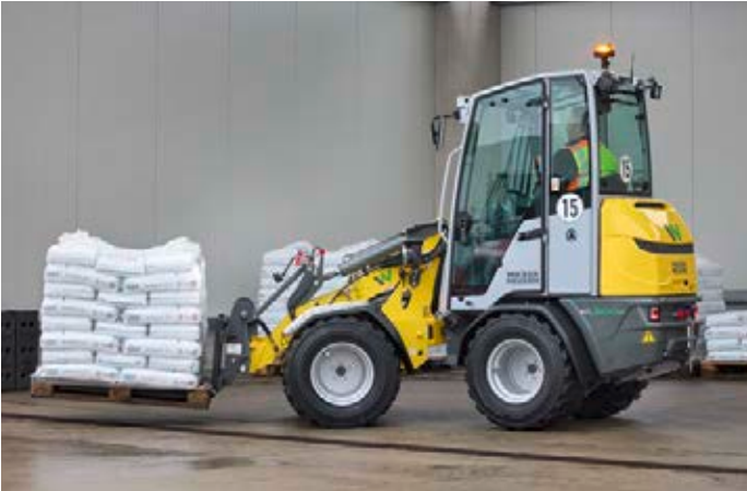
Pålitelig også med tung last: parallellført lastesystem som kan justeres i bredden.
