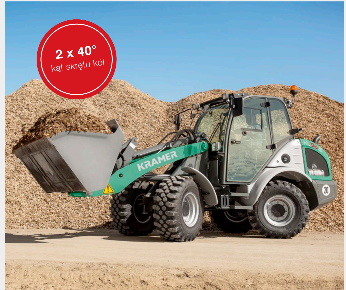
Tryb kierowania na wszystkie koła jest szczególnie przydatny na ograniczonej przestrzeni
