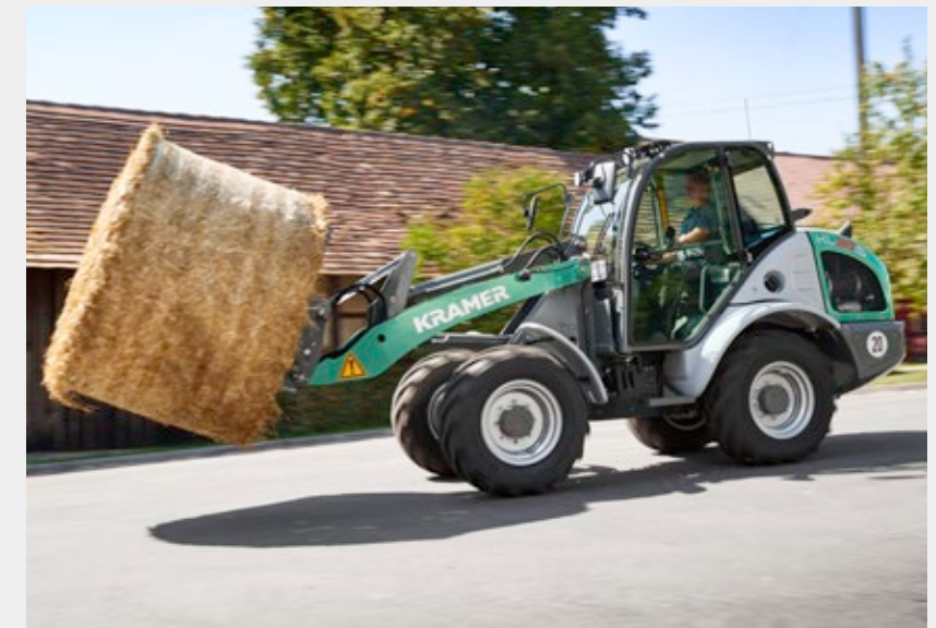
Tryb kierowania na oś przednią zapewnia zwiększone bezpieczeństwo w przypadku szybkich przejazdów transportowych
