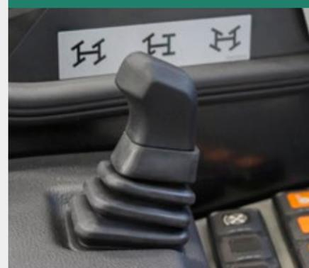
Un cambio tra i tipi di sterzo è possibile con la leva di comando disposta sul cruscotto. Che si tratti di sterzata a quattro ruote motrici, anteriore o a granchio, per ogni applicazione esiste il giusto tipo di sterzo.
