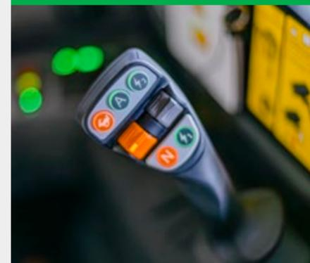
Il joystick multifunzione consente all'operatore di avere sempre tutto a portata di mano. Oltre alle funzioni principali di sollevamento e abbassamento nonché di carico e scarico, tutte le funzioni importanti, compresa la selezione della direzione di marcia si trovano sul joystick. Inoltre, gli elementi di comando del joystick sono retroilluminati nelle situazioni lavoro notturne, il che garantisce un funzionamento sicuro della macchina anche in condizioni di buio.
