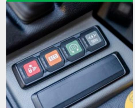
Disponibilità di due modalità di guida: Eco e Auto (PWR). In modalità Auto, l'intera potenza del motore e la velocità di marcia sono disponibili senza restrizioni. In modalità Eco, la potenza del motore e la velocità di marcia sono limitate. Ciò consente il risparmio energetico e l'aumento dell'autonomia.
