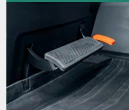
I pedali a sospensione con il pedale freno-inch abbinato consentono manovre precise anche a un alto numero di giri del motore. Inoltre, il pavimento della cabina può essere facilmente rimosso e pulito.
