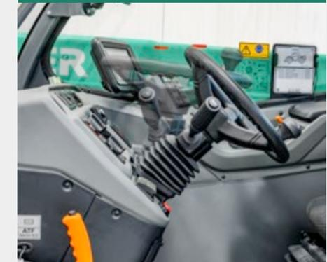
L'inclinazione e l'altezza del piantone dello sterzo possono essere regolate in base alle esigenze dell'operatore. Spingendo verso il basso la leva, il volante si inclina in avanti e all'indietro. Tirare la leva per regolare l'altezza del volante. Inoltre, il volante è realizzato con un materiale di alta qualità e antiscivolo.
