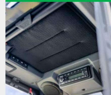
La macchina è equipaggiata di serie con riscaldamento finestrino in cabina. Per raggiungere la massima efficienza energetica possibile per l'intero sistema di riscaldamento, oltre al normale riscaldamento dell'aria, la cabina può essere dotata di un ulteriore riscaldatore di superficie. Questo si trova nel tetto della cabina e genera un calore mirato. È possibile utilizzare il riscaldatore ad aria di serie anche come riscaldatore ausiliario durante la ricarica.
