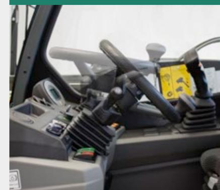
Il piantone dello sterzo e il volante possono essere regolati individualmente a seconda delle esigenze dell'operatore, sia in altezza che in inclinazione. Ciò offre all'operatore più spazio in salita e in uscita. Inoltre, il volante è realizzato con un materiale di alta qualità e antiscivolo.
