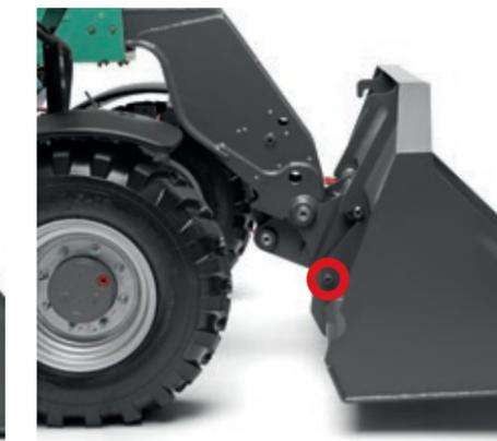
**Cambio attrezzi idraulico (opzione) - L'attacco a cambio rapido Kramer:** avvicinarsi all'attrezzo, prelevare l'accessorio e bloccarlo idraulicamente con la rotellina sul joystick, direttamente dal sedile dell'operatore. Il cilindro di bloccaggio si trova all'esterno del punto di rotazione della piastra di cambio rapido e quindi fuori dall'area esposta allo sporco.
