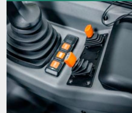
La modalità di guida a pedale/CSD consente di impostare il numero di giri ottimale della macchina e dell'accessorio, nonché la velocità di lavoro corretta. Entrambi i valori possono essere adattati in qualsiasi momento alla situazione di lavoro con l'uso dell'interruttore di punta o del cursore. Ciò garantisce ritmi di lavoro costanti e, allo stesso tempo, senza fatica.
