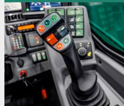
Il joystick precontrollato elettronicamente consente un lavoro estremamente sensibile e preciso. Nonché l'integrazione di sistemi di assistenza al conducente, come Smart Handling, che supporta ulteriormente l'operatore. Per il design notturno innovativo, i vari pulsanti e le ruote sono illuminati a colori.
