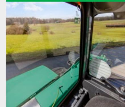
I montanti della cabina stretti e la vetratura panoramica consentono un'eccellente visibilità su tutti i lati. Il parabrezza panoramico migliora la visibilità e il comfort di guida. La copertura piatta della batteria garantisce una visibilità ottimale sul lato destro, sulla ruota posteriore destra e sul parafrangente.
