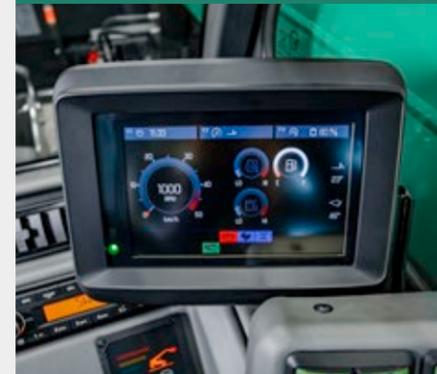
Con il display opzionale da 7 pollici l'operatore gode di una panoramica dei dati attuali della macchina in ogni situazione. Inoltre, il display offre una varietà di funzioni aggiuntive come la sensibilità regolabile del joystick, la velocità di attivazione dello stabilizzatore di carico, l'intervallo di tempo regolabile per la ventola reversibile e la regolazione della quantità di olio per circuiti di controllo supplementari.
