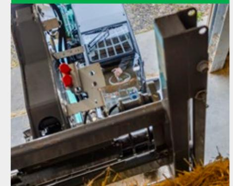
All'interno è installata la griglia FOPS (Falling Object Protective Structure), che consente di mantenere l'altezza del veicolo più bassa possibile. Il design della griglia FOPS consente una visuale ottimale del sistema di carico sollevato. Inoltre, come optional è possibile ordinare una radio con porta USB, riproduzione Bluetooth, DAB+ e sistema vivavoce.
