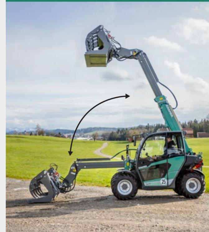
Nella modalità manuale la macchina non esegue alcun movimento automatico dell'unità di carico. La protezione da sovraccarico è naturalmente ancora attiva e arresta l'unità di carico non appena viene raggiunto il limite di sovraccarico. Da questo punto sono ancora possibili la retrazione telescopica e il sollevamento del sistema di carico.
