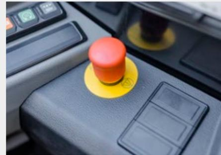
**Interruttore di arresto di emergenza rapidamente accessibile,** in modo che, in caso di pericolo, la macchina possa essere immediatamente messa in condizioni di sicurezza.
