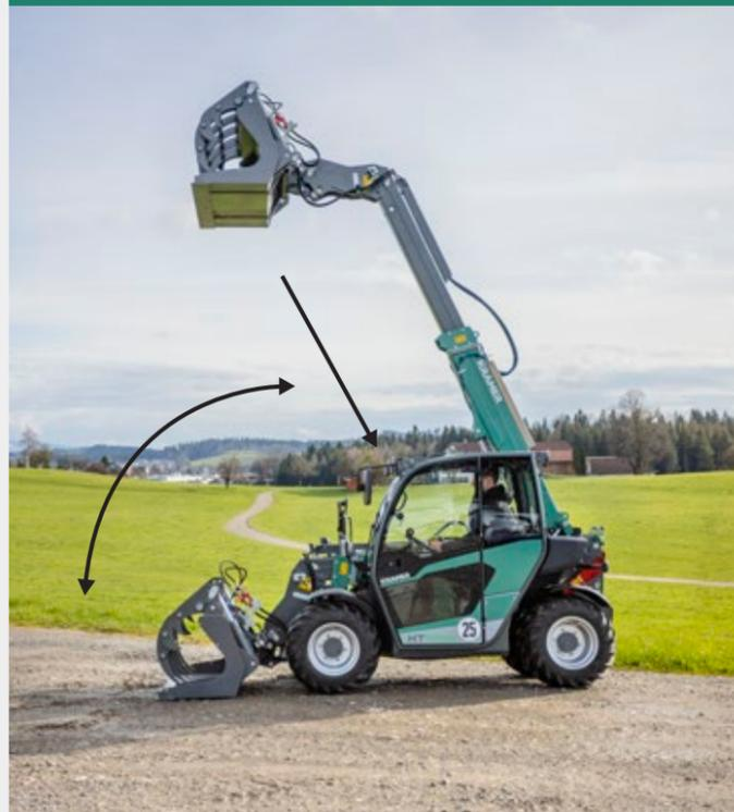
Durante l'abbassamento dell'unità di carico, il braccio telescopico viene ritratto automaticamente. Così il carico viene sempre effettuato il più vicino possibile al veicolo e non si verificano situazioni critiche anche con carichi utili massimi. La modalità benna è perfettamente adatta per il carico di materiali sfusi.
