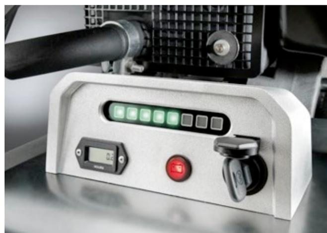
**Indicatore di compattazione Compatec:** indica quando viene raggiunta la compattazione massima con un attrezzo. Per maggiori informazioni visitate il sito: [www.wackerneuson.com/compatec](http://www.wackerneuson.com/compatec)
