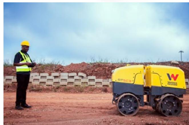
**Sicurezza dell'operatore:** un sensore di prossimità tra l'operatore e la macchina disattiva automaticamente la macchina entro un raggio di 2 metri.
