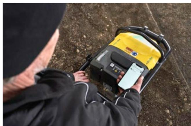
L'app Battery One: informazioni sull'utilizzo della batteria, sullo stato della batteria e sugli aggiornamenti software comodamente tramite smartphone.
