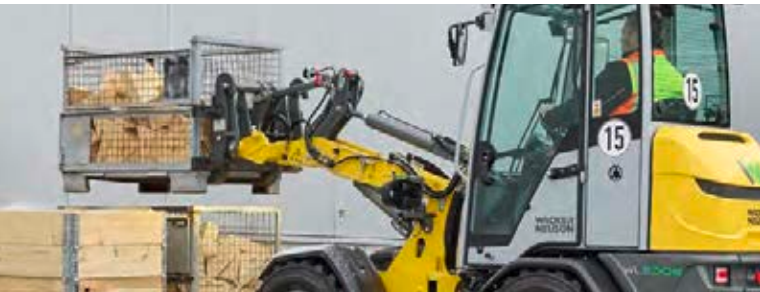
WL300e: den lave forvogn, som fås som ekstraudstyr, sørger i kombination med en kort læssearm for et fremragende overblik og en væsentligt forøget tippelast.
