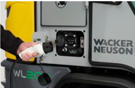
2. Åbn opladningsdækslet, indsæt type 2-stikket på maskinen.
