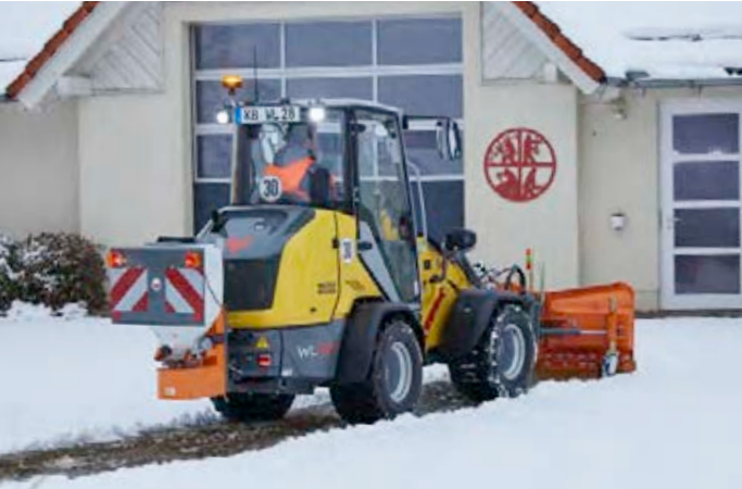
Vintertjeneste på den nemme måde: med sneplov og salt- og grusspreder.
