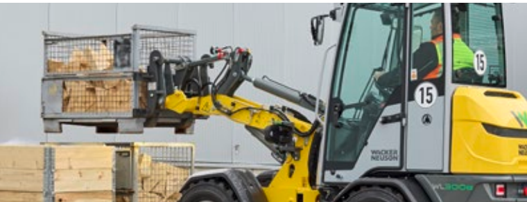
WL300e: den valgfrie lave forvogn i kombination med en kort bom garanterer et fremragende overblik og en væsentligt større tippelast.
