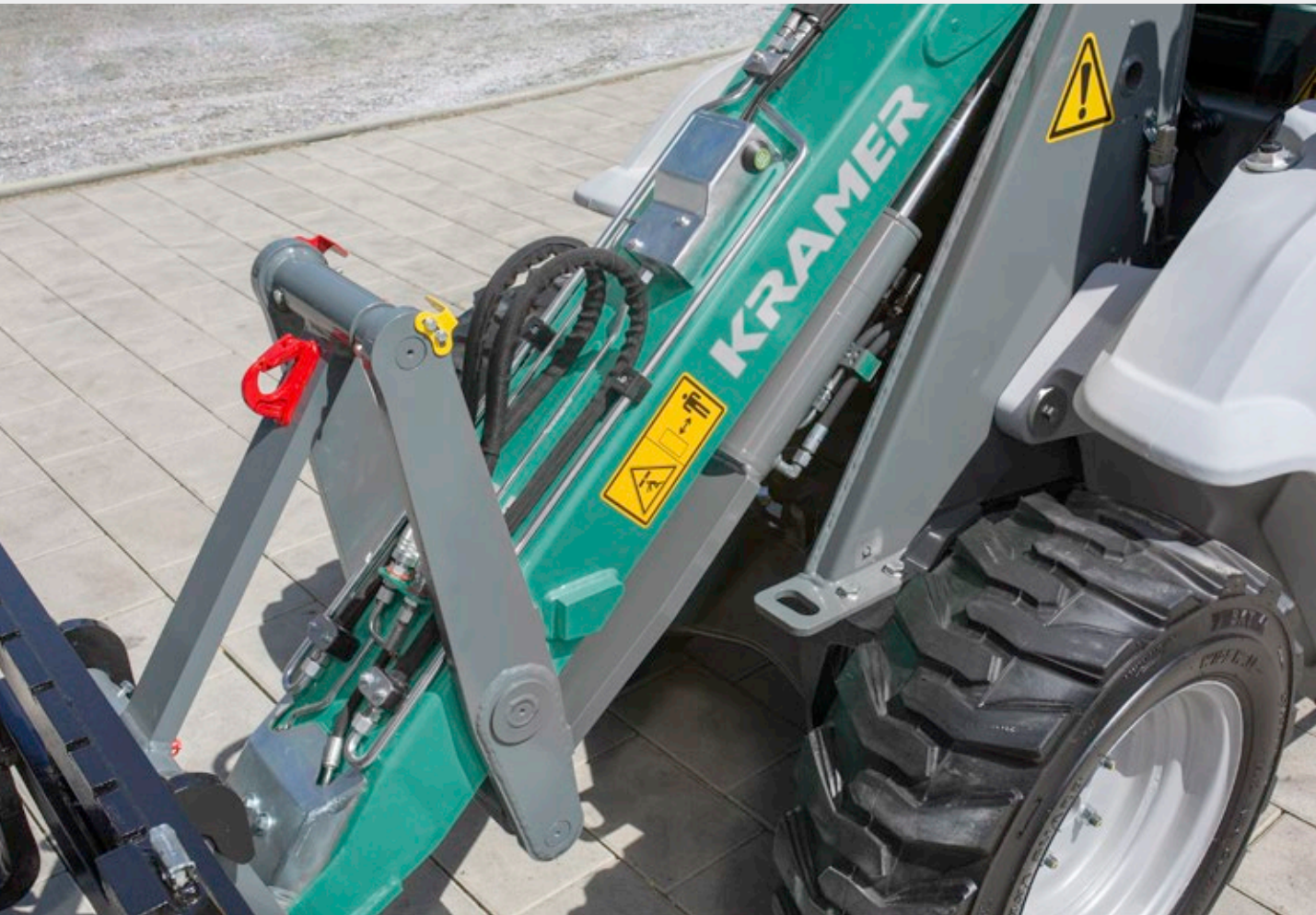
Sistema de carga robusto con cinemática en Z, indicador de posición visual y ganchos de carga opcionales.
