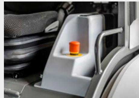
Interruptor de emergencia de rápido acceso , para que la máquina pueda ponerse de inmediato en un estado seguro en caso de emergencia.
