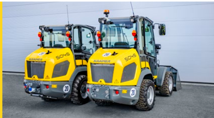
Un confronto tra due principi di cabina: cabina bassa e cabina comfort.
