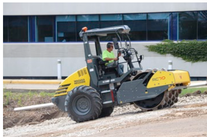
Kontrola trakcji zapewnia, że koła nie ślizgają się nawet na nierównym podłożu.
