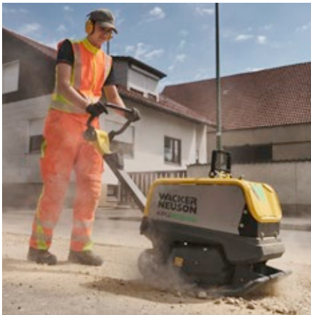
Na jednym naładowaniu akumulatora urządzenie APU3050e zageęści do 333 m² podłoża*.
