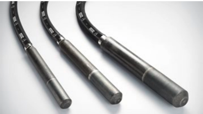
Langlebige und verschleißarme Flaschen, im unteren Drittel gehärtet
