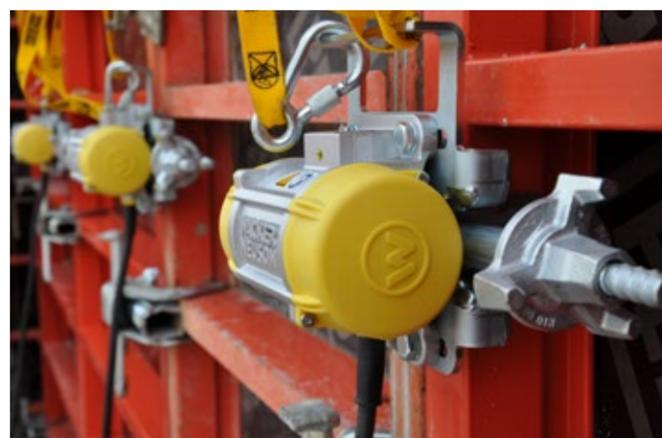
**Flexible para aplicaciones de hormigón en obra.** Para el vibrador externo AR26 hay disponible una gran selección de grapas de sujeción de Wacker Neuson. Estas se pueden montar en todos los encofrados habituales.
