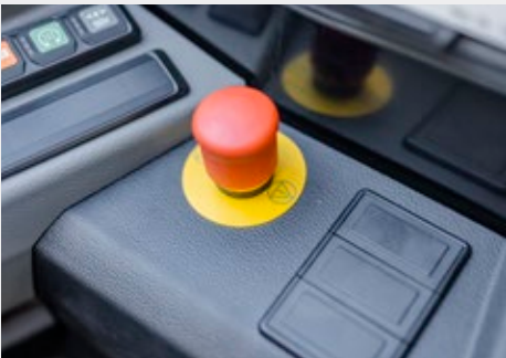
Gyorsan hozzáférhető vészleállító kapcsoló, hogy a gép veszély esetén azonnal biztonságos állapotba hozható legyen.
