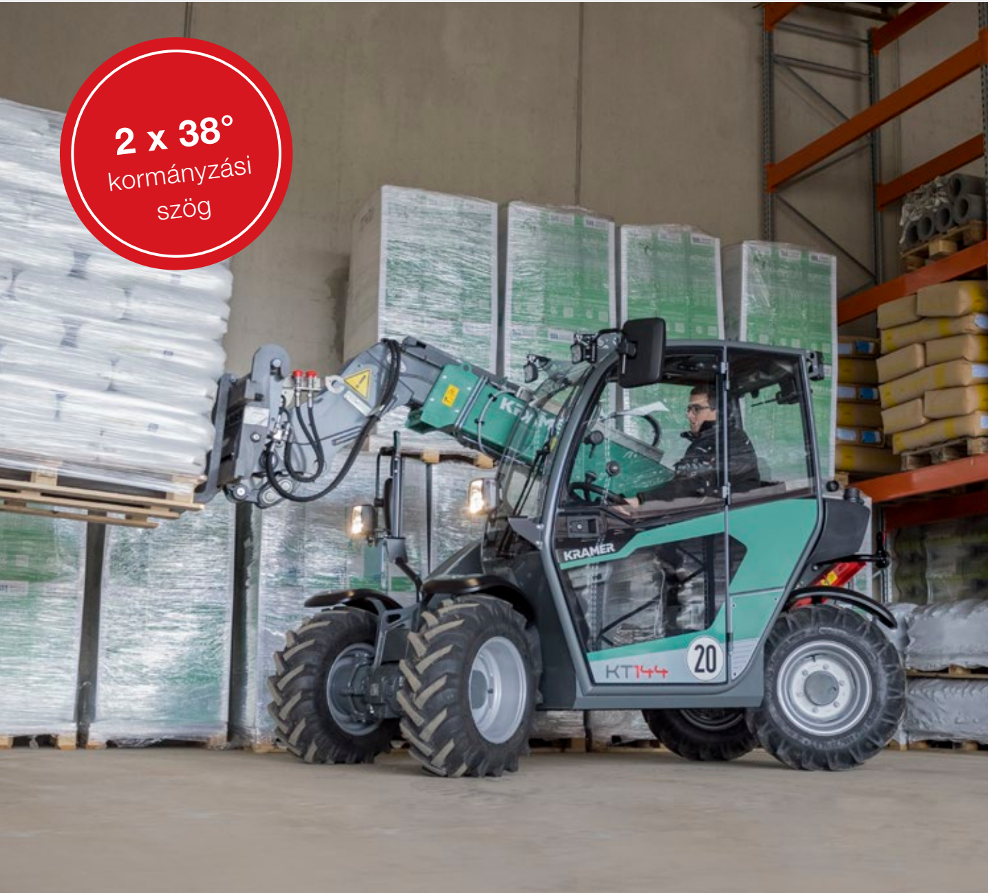
Összkerék-kormányzás: szűkös helyeken is rendkívül jól manőverezhető
