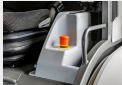
Snel bereikbare noodstop schakelaar om de machine bij gevaar onmiddellijk in een veilige toestand te brengen.
