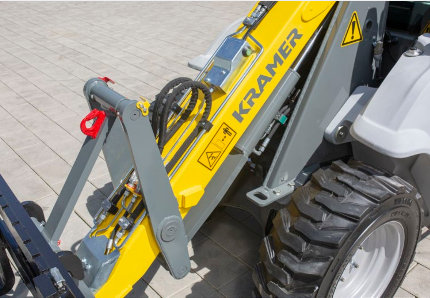
Robuuste laadinrichting met Z-hefinrichting, visuele positieaanduiding en optionele hefhaken.
