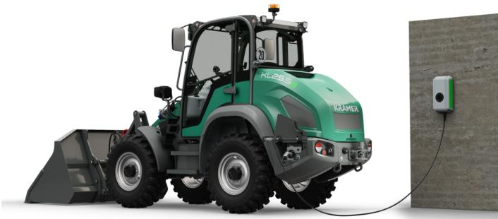
**Recharge :** Chargeur intégré avec jusqu'à 9 kW permettant une recharge rapide
