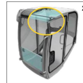
El parabrisas superior se puede deslizar por debajo del techo de la cabina. El parabrisas inferior sirve de protección contra salpicaduras.
