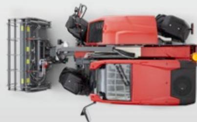
**Hundeganglenkung.** Seitwärtsfahren für zentimetergenaues rangieren unter beengten Verhältnissen, wie z. B. Schiebearbeiten an Wänden.
