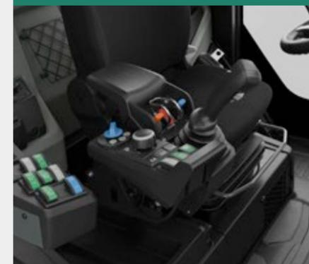
Кабина оборудована так называемым «поворотным переключателем». С его помощью можно удобно осуществлять все важные настройки машины, например, количество масла, подаваемого в отдельные гидравлические контуры управления. Наиболее важные эксплуатационные параметры могут выводиться на экран при помощи вращающегося нажимного колесика в полном соответствии с требованиями оператора.
