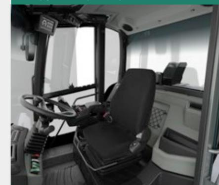
Благодаря конструкции кабины оператор защищен от шумовой эмиссии (70 дБ(А)). Кроме того, автоматической системой кондиционирования воздуха, фарами рабочего освещения и стеклоочистителем заднего стекла можно управлять при помощи переключателей сбоку над 7-дюймовым дисплеем. Другие характеристики кабины: Bluetooth-радиоприемник с устройством громкой связи, розетка 12 В с защитным колпачком, два USB-порта и многое другое.
