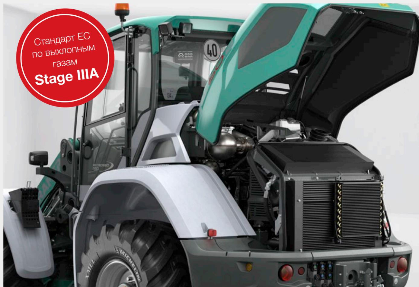
4-цилиндровый рядный двигатель с водяным охлаждением турбонаддувом и промежуточным охлаждением.
