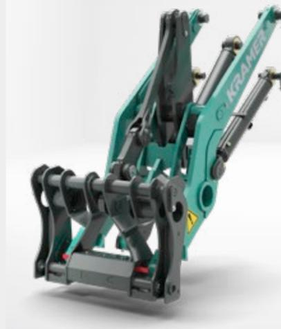
Подъемная PZ-рама объединяет в себе самое лучшее от параллельной кинематики и Z-кинематики и тем самым гарантирует высокую силу черпания и точное параллельное движение по всей длине хода.
