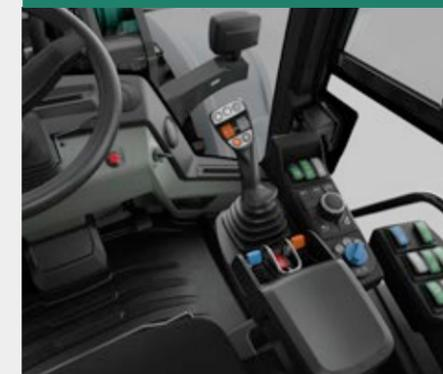
Подлокотник, включая панель с рычагом управления и jog dial, смонтирован на сиденье и оснащен важнейшими элементами управления. Таким образом, левая рука может оставаться на рулевом колесе, а правая рука – в области подлокотника. Подлокотник может откидываться вверх и благодаря этому обеспечивает возможность выхода из кабины справа.
