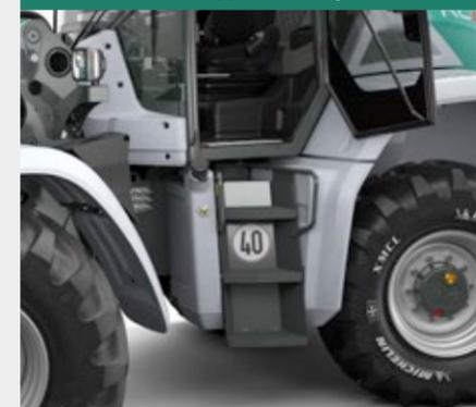
В кабину можно войти с обеих сторон через большие проемы и подножки с тремя ступеньками. Четыре поручня (один слева на передней стойке, два на подножке и один на двери) позволяют безопасно садиться в кабину и покидать ее с обеих сторон. Кроме того, доступно внутреннее освещение с дверным контактным выключателем.
