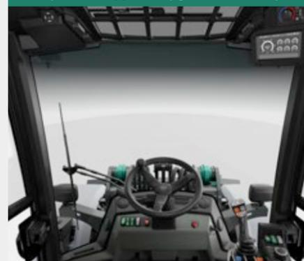
Большая площадь остекления в сочетании с открытой конструкцией стеклянной крыши, а также интегрированной камерой заднего вида обеспечивают превосходный круговой обзор в новой кабине: при взгляде на навесное оборудование, непосредственно на рабочую зону и на все окружение машины.
