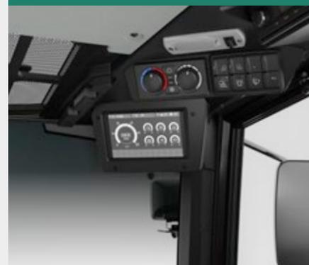
Машины оснащены полностью новой концепцией управления с большим 7-дюймовым ЖК-дисплеем. Структура 7-дюймового дисплея отличается простотой и интуитивностью. Все основные показатели о работе транспортного средства и функции показаны в главном меню. Яркость можно регулировать и изменять в соответствии с индивидуальными требованиями.
