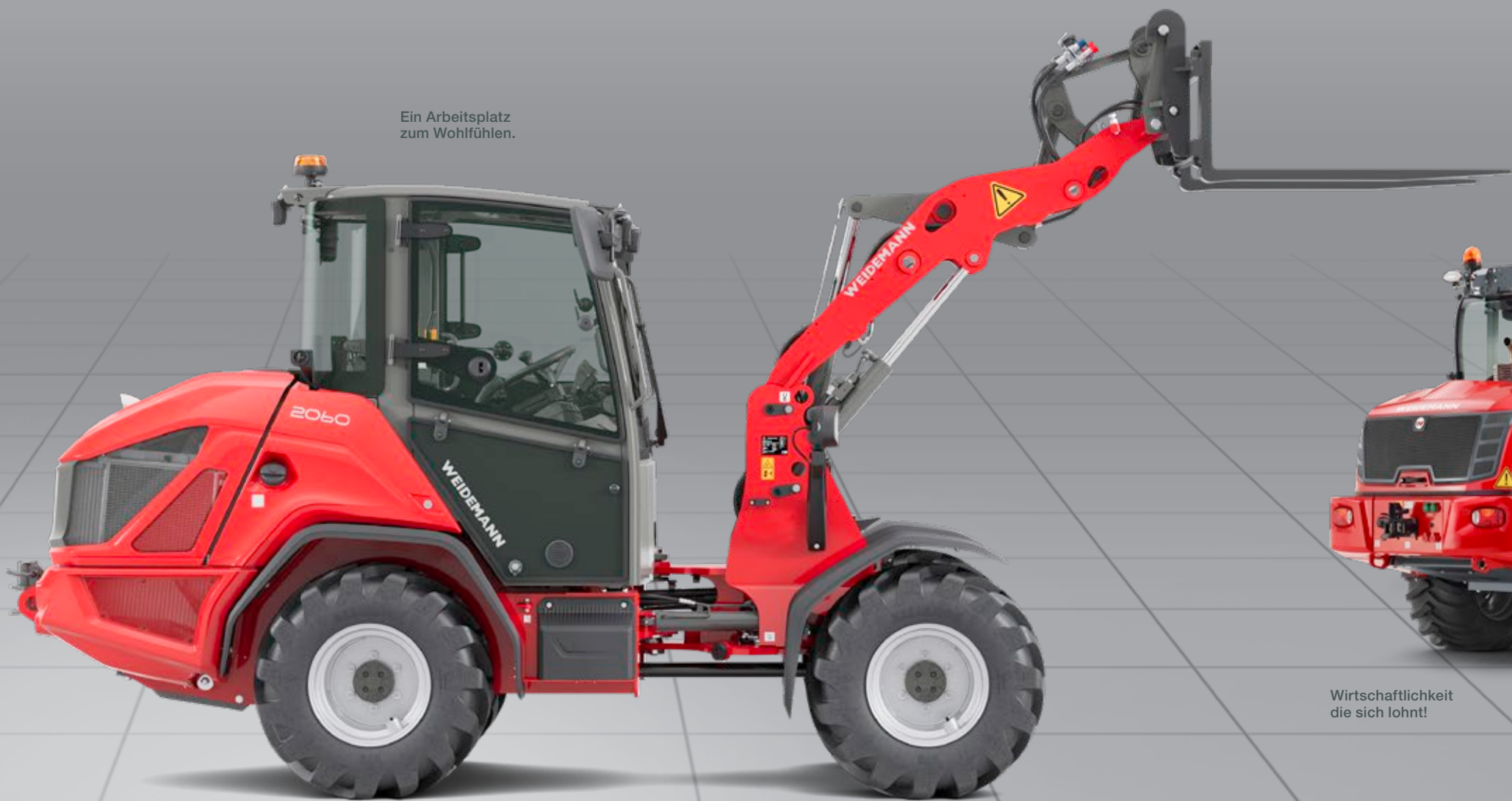
Hohe Geländegängigkeit mit Knick-Pendel-Gelenk.
