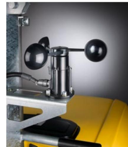
Windsensor senkt den Mast automatisch bei hoher Windstärke ab.
