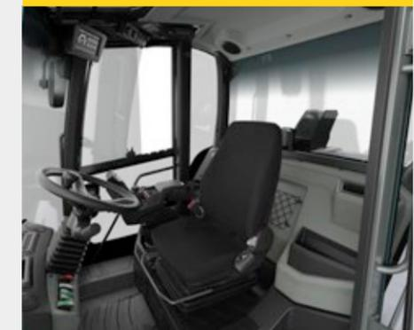
Grazie al design della cabina, l'operatore viene protetto dalle emissioni acustiche (70 dB(A)). Inoltre il climatizzatore automatico, i fari di lavoro e il tergilunotto vengono comandati lateralmente sopra il display da 7 pollici. Altre caratteristiche della cabina sono: Radio Bluetooth con dispositivo viva voce, presa da 12 V con cappa di protezione, due attacchi USB e molto altro.
