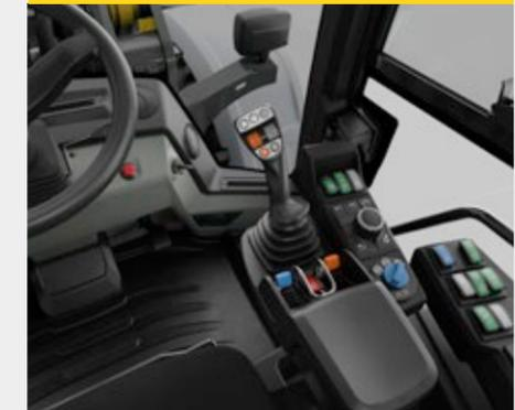
Il bracciolo, con console del joystick e Jog Dial, è montato sul sedile dell'operatore e dotato dei più importanti elementi di comando. In questo modo la mano sinistra può rimanere sul volante e la mano destra nell'area del bracciolo. Il bracciolo è ribaltabile verso l'alto e rende quindi possibile l'uscita anche verso destra.
