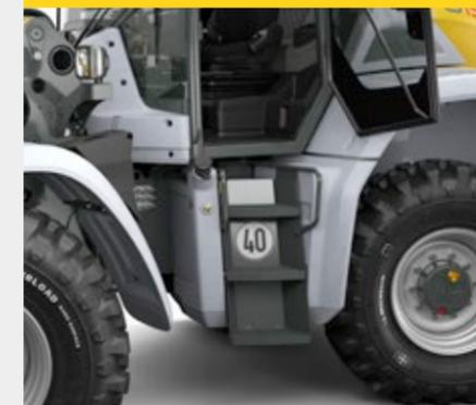
La cabina è perfettamente raggiungibile grazie all'ampia area di salita dai due lati con tre gradini disposti a scala. Quattro maniglie (una a sinistra sul montante A, due sulla scaletta e una sulla porta) consentono una salita e una discesa sicura su entrambi i lati. È presente anche l'illuminazione interna con interruttore a contatto nel sedile.
