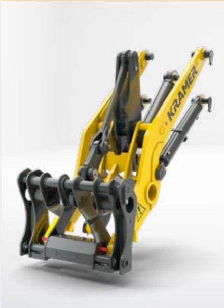
Il montante PZ combina il meglio della cinematica parallela e Z in un unico sistema e assicura così un'elevata forza di strappo e una precisa guida parallela sull'intera area di sollevamento.
