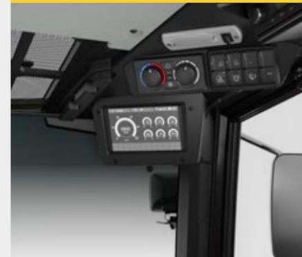
Le macchine con un principio di funzionamento completamente nuovo sono dotate di un ampio display LCD da 7 pollici. La struttura del display da 7 pollici è semplice e intuitiva. Tutti i dati e le funzioni rilevanti del veicolo vengono visualizzati nel menu principale. La luminosità può essere regolata e personalizzata in base alle proprie esigenze.
