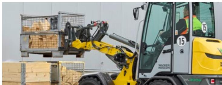
WL300e: Der optional verfügbare niedrige Vorderwagen in Kombination mit einer kurzen Ladeschwinge sorgen für eine hervorragende Übersicht und eine deutlich gesteigerte Kipplast.
