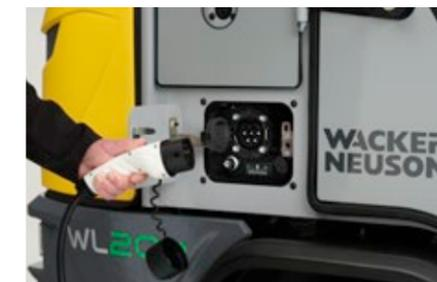
2. Ladeklappe öffnen, Typ-2-Stecker maschinenseitig einstecken.
