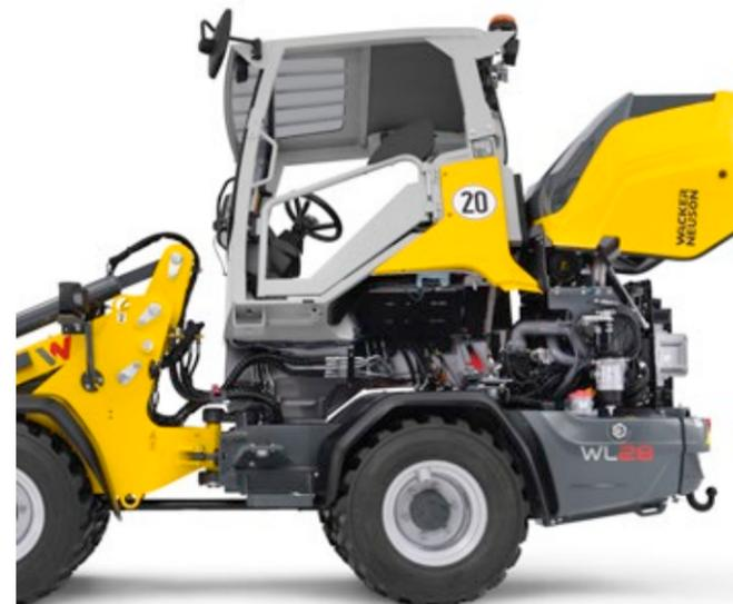
WL20, WL25 und WL28 sind mit einem kippbaren Fahrerstand bzw. einer kippbaren Kabine ausgestattet. Dies ermöglicht einen unkomplizierten Zugang zum Motor, dem Hydrauliksystem und der Elektrik. Auch die Motorhaube lässt sich weit öffnen und bietet so optimalen Zugang.
