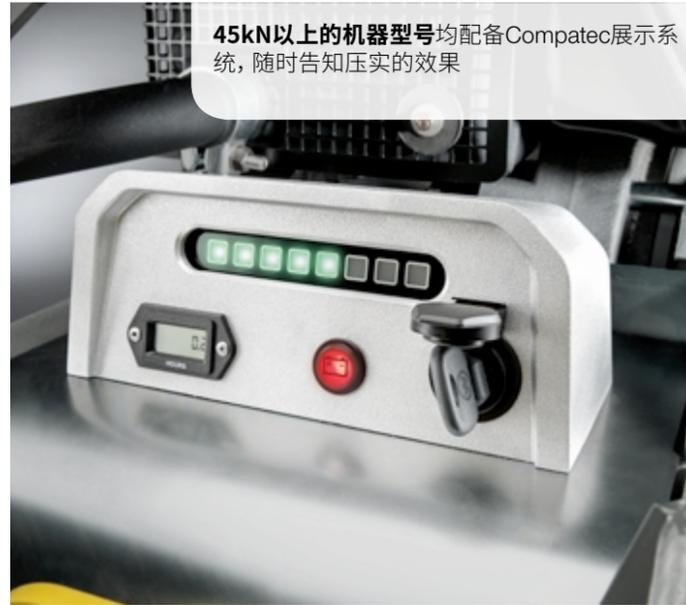
45kN以上的机器型号均配备Comptec展示系统, 随时告知压实的效果
