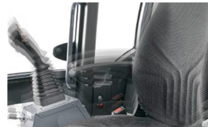
Console joystick réglable sur le siège conducteur.
