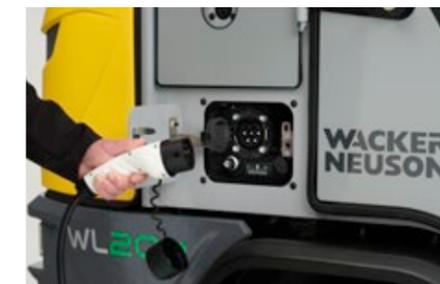
2. Ouvrir la trappe de recharge, insérer le connecteur de type 2 côté machine.
