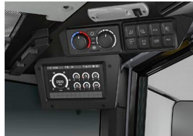
Avec l'écran numérique 7", vous gardez tout à l'œil : Outre les indicateurs de base comme la température, le niveau remplissage de carburant ou les heures de service, les fonctions en cours d'utilisation s'affichent également sur le tableau de bord, par exemple les fonctions électriques activées, le fonctionnement en mode continu du 3<sup>e</sup> circuit hydraulique ou l'enclenchement du blocage de différentiel.
