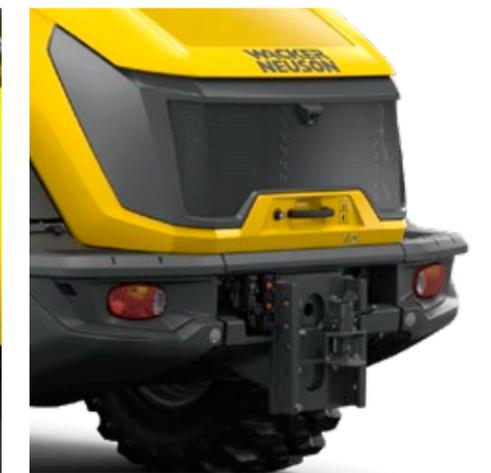
Remorque jusqu'à 18 t : La WL95 et la WL110 sont équipées de série d'un crochet de remorquage. De plus, les possibilités d'attelage suivantes sont disponibles : dispositif d'attelage automatique, boule d'attelage K50 (remorque de voiture), Auto Hitch, Piton Fix et CUNA D3. Afin de déplacer en toute sécurité les charges de la remorque, un frein pneumatique à double conduite ainsi qu'un frein hydraulique pour remorque sont installés.
