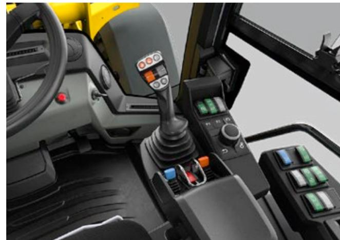
Réglage du débit d'huile hydraulique à l'aide du « Jog Dial » : Si un équipement hydraulique n'a pas besoin de toute la puissance hydraulique, le débit peut être réduit manuellement. L'opérateur peut travailler avec précision, en préservant les ressources, à la fois avec la machine et l'équipement hydraulique.
