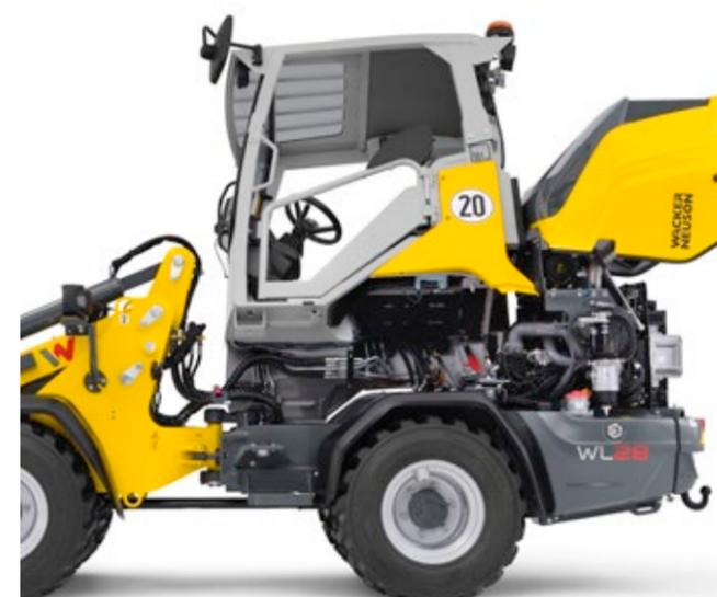
Les trois chargeuses sur pneus sont équipées d'un poste de conduite basculant / cabine basculante. L'accès au moteur, aux systèmes hydraulique et électrique s'en retrouve ainsi facilité. Le capot-moteur à ouverture large offre un accès optimal.
