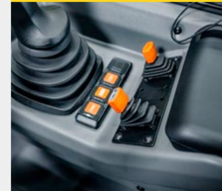
Le mode de conduite pédale/CSD permet de régler le régime moteur optimal de la machine et de l'accessoire, ainsi que la vitesse de travail correcte. Ensuite, les deux valeurs peuvent être adaptées à tout moment à la situation de travail à l'aide d'un jog switch ou d'un curseur. Cela permet des opérations de travail constantes et en même temps de manière confortable.
