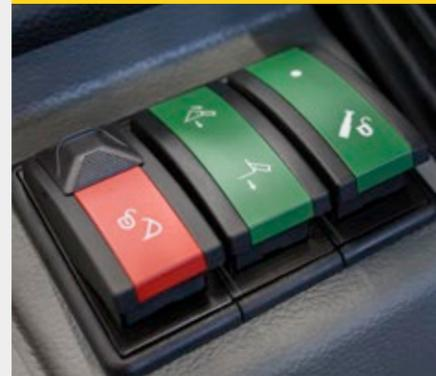
Le marquage couleur des interrupteurs permet d'identifier chaque groupe de fonctions très rapidement. Rouge = sécurité, Vert = hydraulique, Bleu = conduite et Gris = électrique. Le conducteur dispose ainsi de conditions de pilotage confortables et sûrs, sans risque de confondre les boutons. Il en résulte une efficacité de travail accrue.
