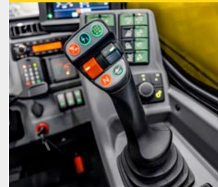
Le joystick à pré-commande électronique permet une utilisation extrêmement sensible et précise ainsi que l'intégration de systèmes d'aide à la conduite, tels que Smart Handling, qui assistent encore davantage le conducteur. Dans le design nocturne innovant, les différents boutons et roues s'illuminent en couleur.
