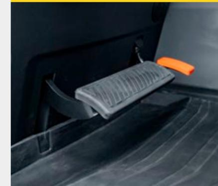
Les pédales suspendues avec la pédale de frein inching combinée permettent des manœuvres sensibles même à des régimes moteur élevés. En outre, le plancher de la cabine peut être facilement retiré et nettoyé.
