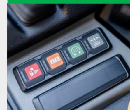
Deux modes de conduite sont disponibles : Eco et Auto (PWR). En mode Auto, toute la puissance du moteur et la vitesse de conduite sont disponibles sans restriction. En mode Eco, la puissance du moteur et la vitesse de déplacement sont limitées. On économise ainsi de l'énergie et on gagne en temps de fonctionnement.
