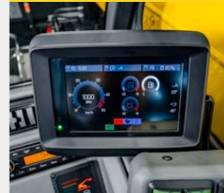
L'écran 7 pouces permet au conducteur d'avoir à tout moment une vue d'ensemble des données actuelles de la machine. Il propose en outre de nombreuses fonctions supplémentaires comme le réglage de la sensibilité du joystick, la vitesse d'activation du stabilisateur de charge, l'intervalle du ventilateur réversible et le réglage de la quantité d'huile pour le circuit supplémentaire.
