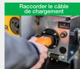
Ouvrir la console de chargement et brancher le câble de chargement sur la machine.
