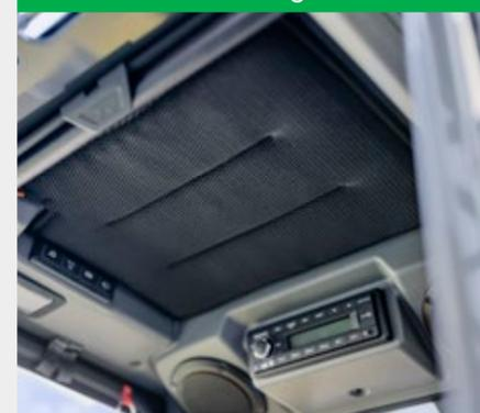
La machine est équipée de série d'un chauffage de la vitre de la cabine. Afin d'obtenir une efficacité énergétique maximale pour l'ensemble du système de chauffage, la cabine peut être équipée d'un chauffage de surface supplémentaire en plus du chauffage à air normal. Celle-ci se trouve dans le toit de la cabine et diffuse de la chaleur de manière ciblée. Le chauffage à air normal peut également être utilisé comme chauffage d'appoint.
