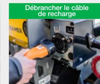
Actionner l'interrupteur à clé\* et débrancher la prise de charge. Fermer ensuite la console de chargement.
