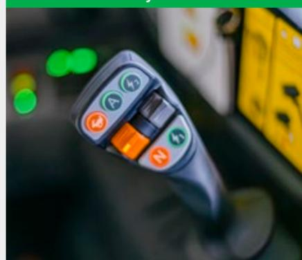
Grâce au joystick multifonctions, le conducteur a tout sous la main à tout moment. Outre les fonctions principales de levage et d'abaissement, ainsi que de basculement et de déversement, toutes les fonctions importantes sont regroupées sur le joystick, y compris la sélection du sens de déplacement. De plus, les éléments de commande du joystick sont rétroéclairés la nuit, ce qui garantit une utilisation sûre de la machine même dans l'obscurité.
