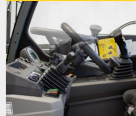
La colonne de direction et le volant peuvent être réglés individuellement en fonction des besoins du conducteur, tant en hauteur qu'en inclinaison. Cela permet également au conducteur d'avoir plus d'espace pour monter et descendre du véhicule. En outre, le volant est fabriqué dans un matériau de haute qualité et offre une bonne prise en main en option.
