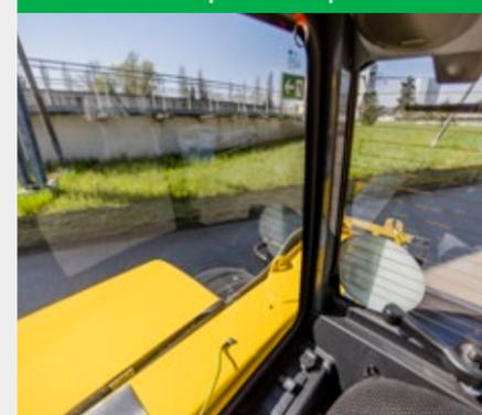
Les montants étroits de la cabine et le vitrage panoramique permettent une excellente visibilité de tous les côtés. Le pare-brise avant panoramique contribue à une bonne visibilité et améliore le confort de conduite. Le capot plat de la batterie assure une visibilité optimale sur le côté droit, sur la roue arrière droite et sur le garde-boue.
