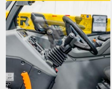
La colonne de direction peut être réglée en inclinaison et en hauteur pour s'adapter aux besoins du conducteur. En appuyant le levier, il est possible de basculer le volant en avant et en arrière. En tirant le levier, le volant est réglé en hauteur. En outre, le volant est recouvert d'un matériau de haute qualité et antidérapant (en option).
