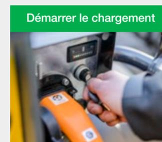
Actionner l'interrupteur à clé\* pour démarrer le chargement. L'indicateur de charge à l'arrière de la machine se met à clignoter.
