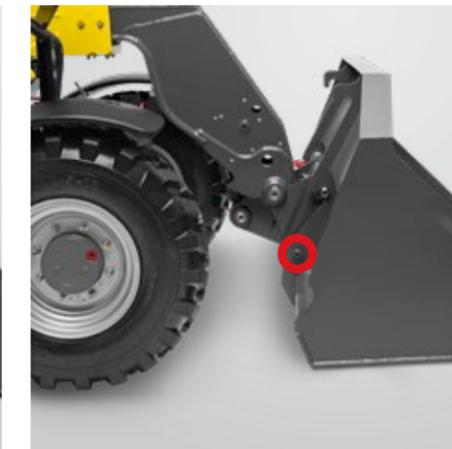
**Changer d'équipement hydraulique (en option) : le système d'attache rapide Kramer :** S'approcher de l'accessoire, prendre l'accessoire depuis le siège du conducteur et le verrouiller hydrauliquement à l'aide du bouton-poussoir à roulette du joystick. Le cylindre de verrouillage se trouve en dehors de la zone sale.
