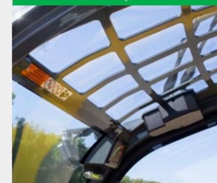
La grille FOPS (Falling Object Protective Structure) est placée à l'intérieur afin de réduire au maximum la hauteur du véhicule. Grâce à la conception de la grille FOPS, la visibilité sur l'installation de chargement soulevée est optimale. En outre, une radio avec connexion USB, lecture Bluetooth, DAB+ et dispositif mains libres peut être commandée en option.
