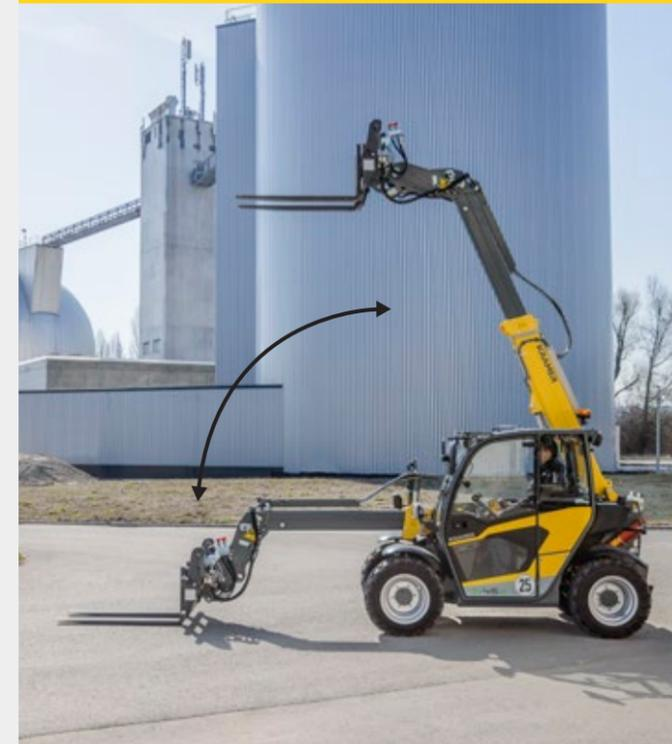
En mode manuel, la machine n'effectue aucun mouvement automatique de l'installation de chargement. La protection contre les surcharges reste bien entendu active et arrête le chargeur dès que la limite de surcharge est atteinte. À ce moment, il est uniquement possible de rétracter et soulever le bras chargeur et de basculer l'équipement.
