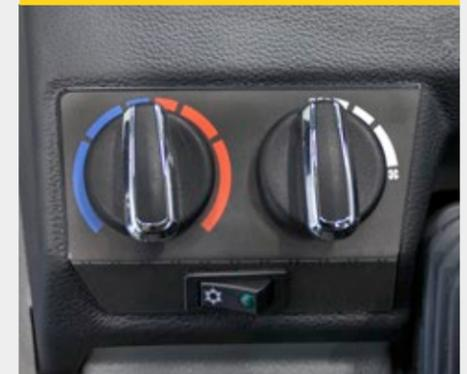
Le système de chauffage et de ventilation avec ventilateur, filtre à air frais et buses d'aération bien placées assurent un climat de travail agréable. Pour les températures extérieures particulièrement chaudes, la climatisation en option est recommandée. En outre, le véhicule est équipé d'un pare-soleil réglable pour un travail sans éblouissement.
