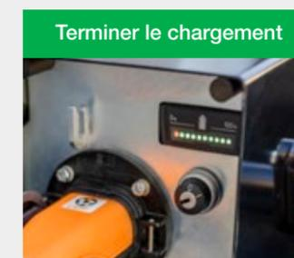
L'indicateur de charge s'allume en continu dès que le processus de charge s'est terminé automatiquement.
