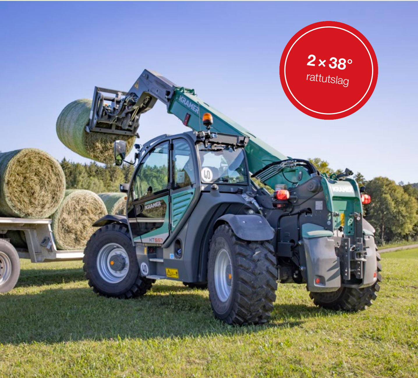
Fyrhjulsstyrning för maximal manövreringsförmåga
