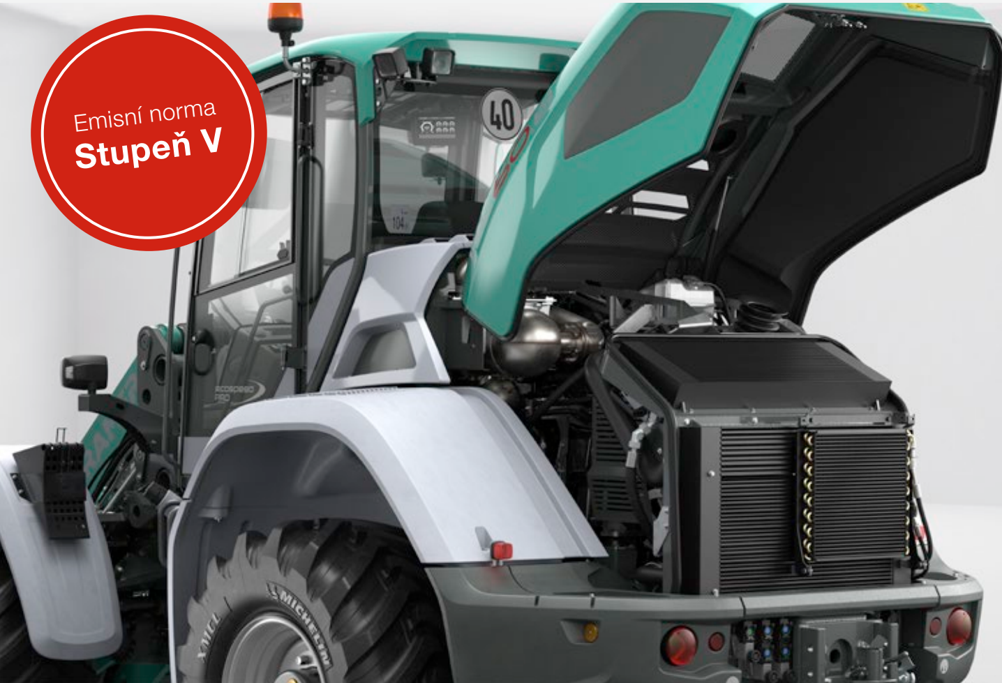
Vodou chlazený čtyřválcový řadový motor s recirkulací výfukových plynů, turbodmychadlem a mezichladičem.
