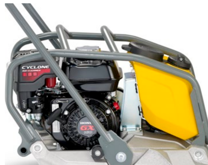
Der Rohrrahmen mit integrierter Kranöse kann auch seitlich als Führungsgreif verwendet werden, ideal zur Verdichtung entlang von Kanten.
