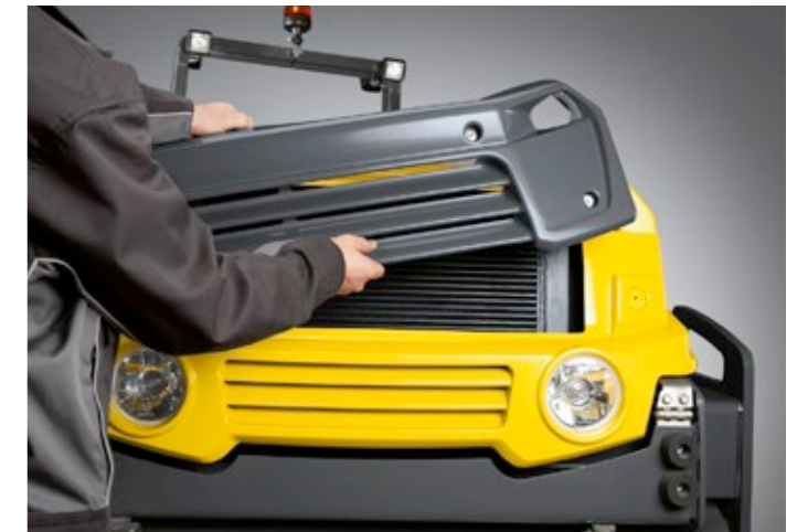
Einfache Kühlerreinigung durch separat abnehmbare Klappe.
