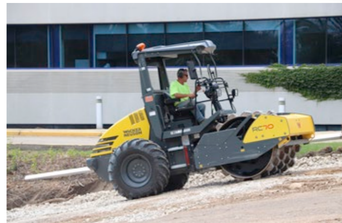
Die Traktionskontrolle sorgt dafür, dass die Räder auch in unebenem Gelände nicht durchdrehen.
