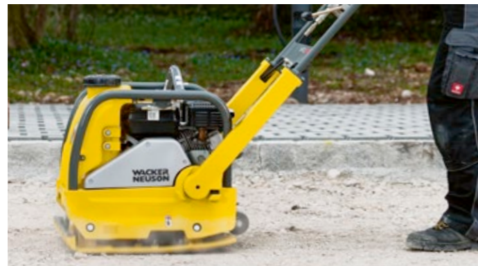
Sehr gut zu manövrieren: dank speziell geformter Grundplatte der WPU1550.
