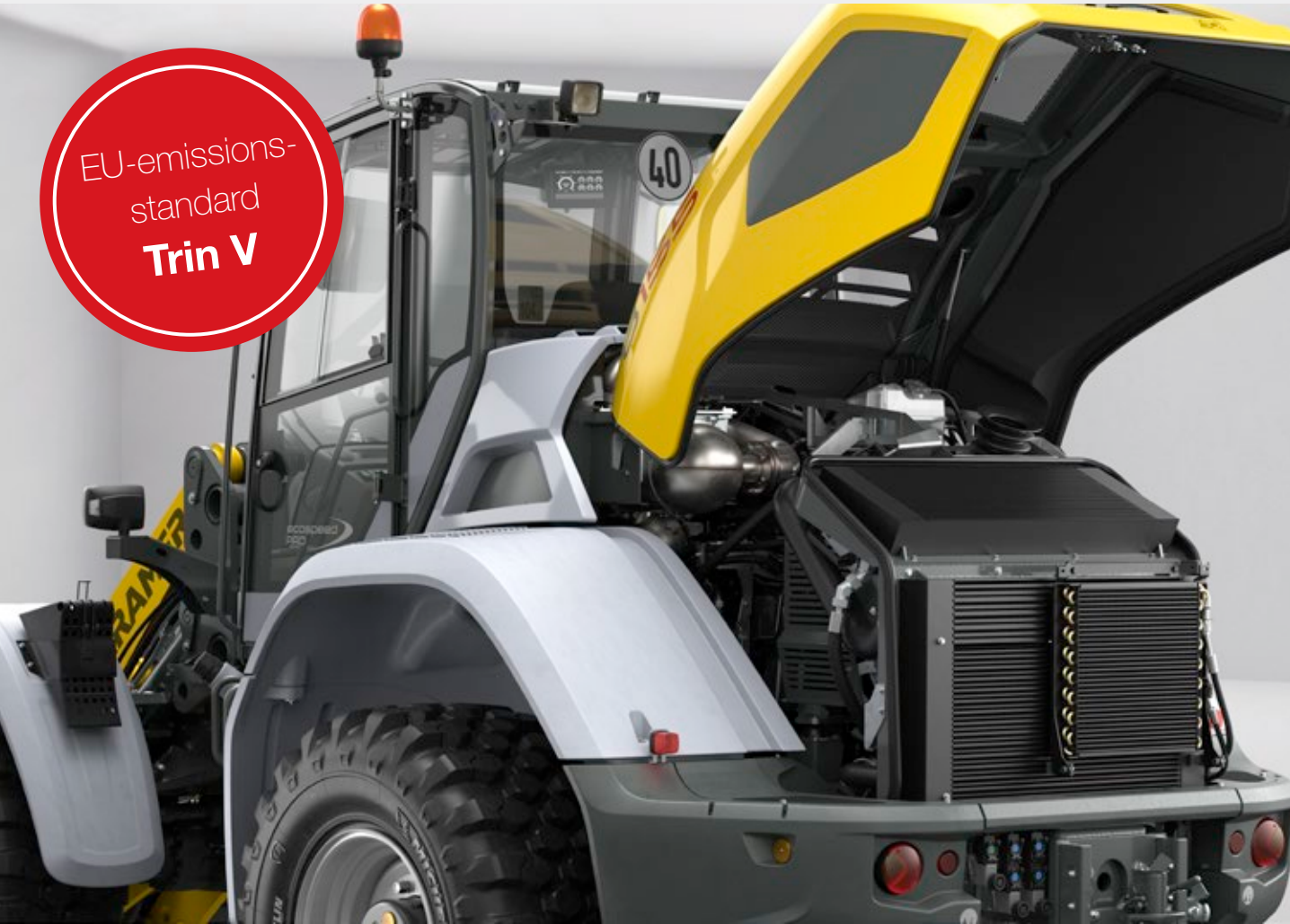
Vandkølet 4-cylindret rækkemotor med kølet eksternt tilbageføring af udstødningsgas, turboladning samt ladeluftkøling.
