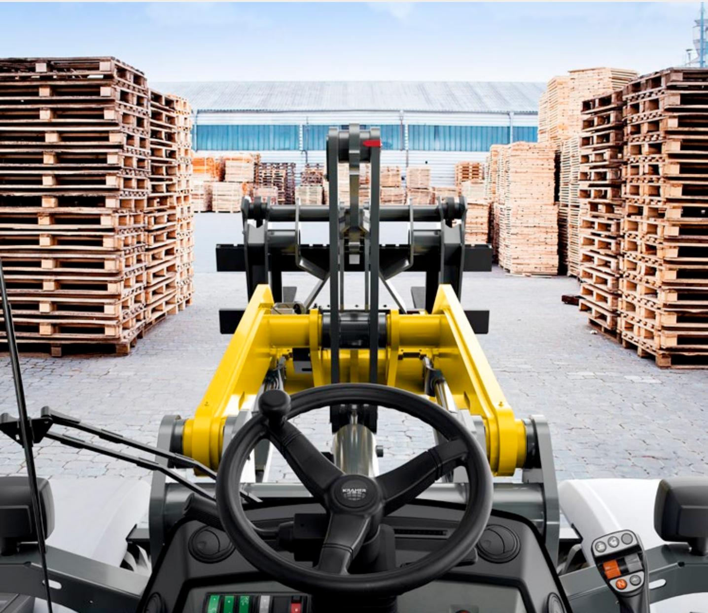
Fremragende panoramaudsyn: smalle kabinesøjler og panoramavinduer giver et optimalt udsyn til alle sider.
