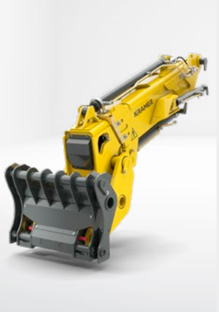
Teleskoplæssesystem (Z-kinematik) med Kramer-hurtigskifteplade
