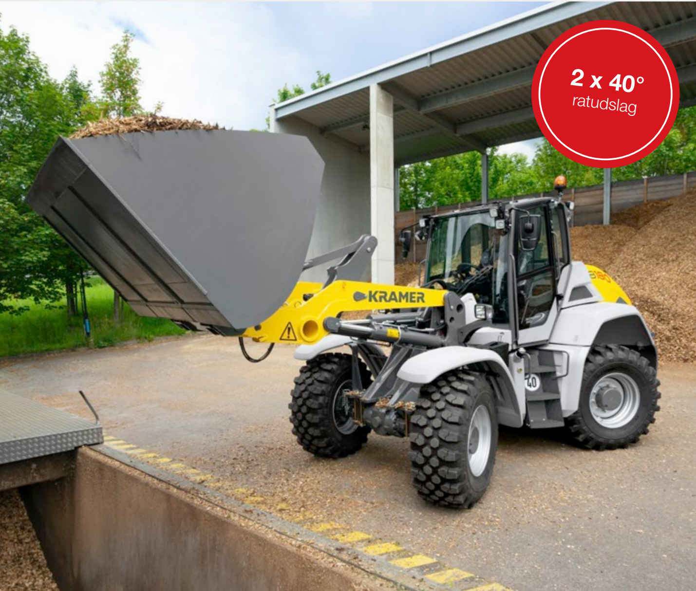
Firehjulsstyring særligt manøvreedygtig ved indskrænkede pladsforhold
