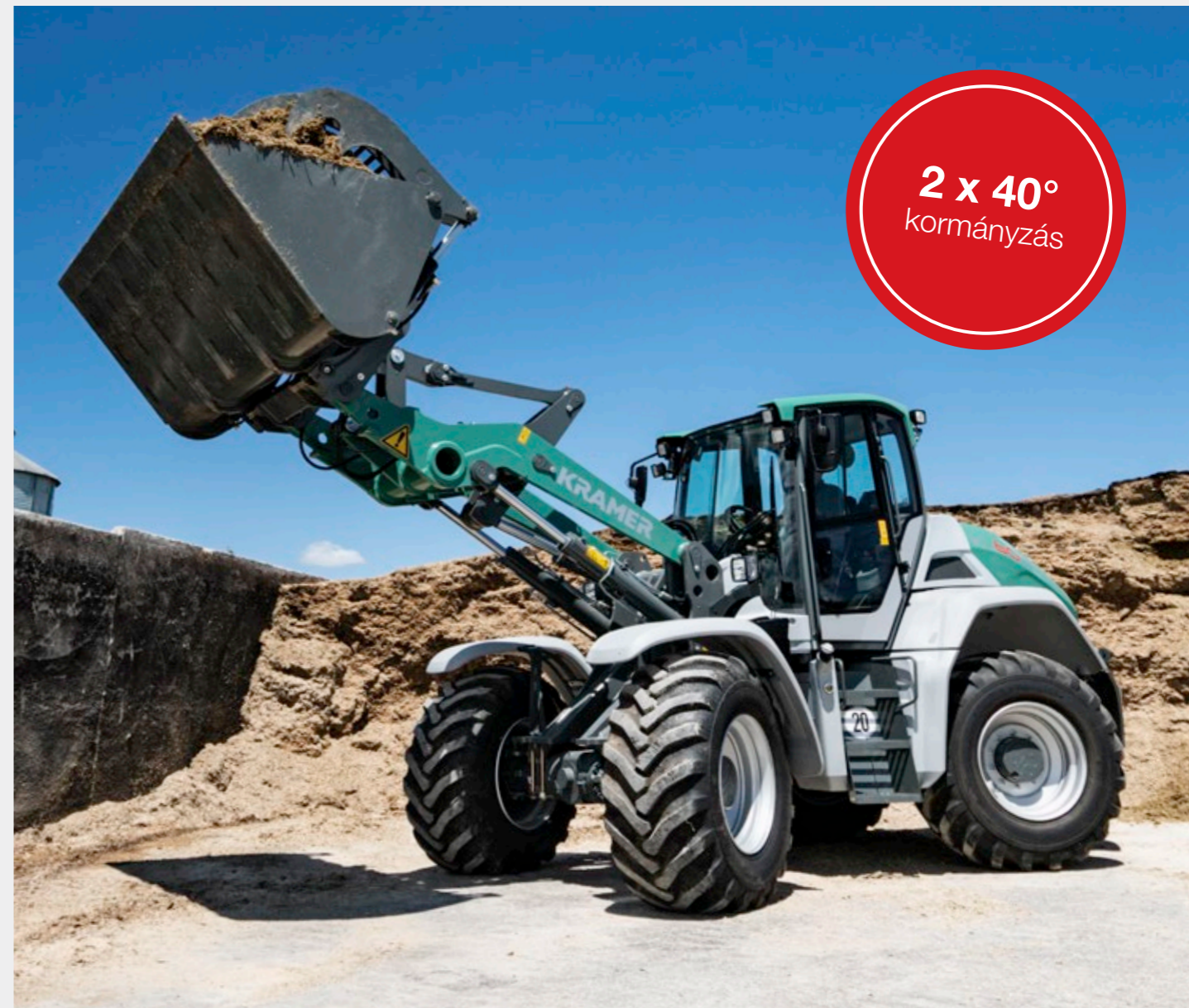
Az összkerék kormányzással különösen jól manőverezhető szűk helyeken
