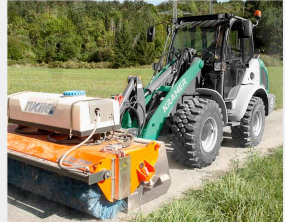
**CSD - vitesse d'avancement constante** : contribue au respect d'une vitesse d'avancement définie, en particulier lors de l'utilisation d'équipements nécessitant une vitesse constante pour effectuer correctement un travail – par exemple : godet désileur, balayeuse.
