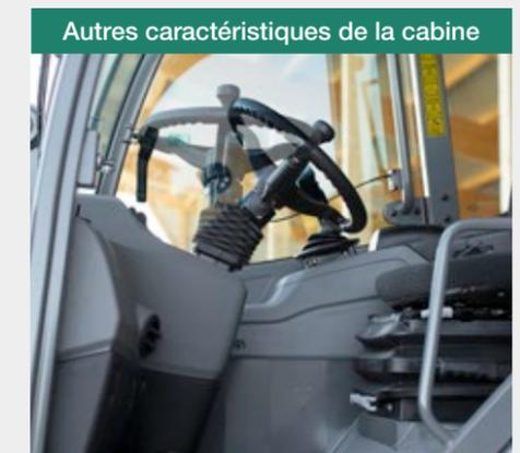
La colonne de direction à inclinaison réglable fait partie de la large gamme d'équipements de série. De plus, le rétroviseur intérieur et les quatre phares de travail assurent une visibilité optimale. La machine peut être équipée en option d'un siège conducteur chauffant avec suspension pneumatique et maintien lombaire.
