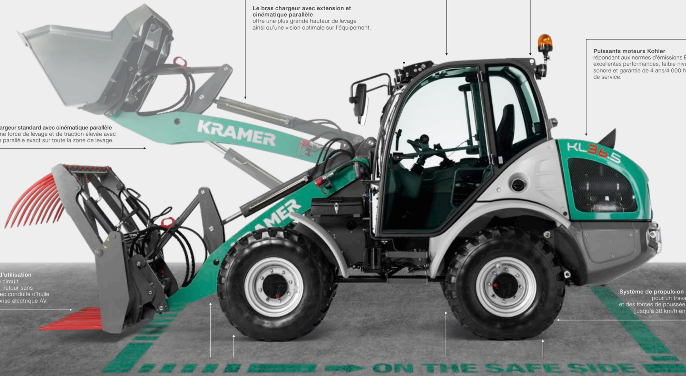
**Le bras chargeur standard avec cinématique parallèle** combine une force de levage et de traction élevée avec un guidage parallèle exact sur toute la zone de levage.
