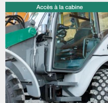
La large porte permet d'accéder à la cabine de l'opérateur. Afin que l'opérateur puisse accéder de manière encore plus pratique à la machine, un marchepied avec deux marches est disponible en option.\* De plus, les poignées d'accès sont positionnées de manière à garantir une bonne ergonomie.
