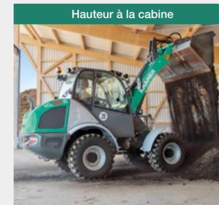
Grâce à leurs dimensions compactes et basses, moins de 2,50, les chargeuses sur pneus sont parfaitement adaptées à une utilisation dans des cours de ferme ou des étables exigües. Grâce à leur conception, les machines disposent des meilleures caractéristiques pour travailler dans des bâtiments à faible hauteur d'entrée.
