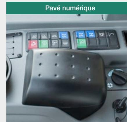
Les interrupteurs à code couleur permettent d'identifier très rapidement le groupe de fonctions auquel ils sont rattachés. Rouge = sécurité, vert = hydraulique, bleu = conduite et gris = électrique. L'opérateur peut ainsi utiliser sa machine en toute sécurité, et sans risque de se tromper. Il en résulte une efficacité de travail accrue.
