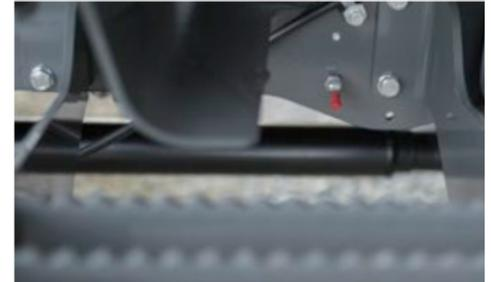
**Crochet de levage sur la barre de cavage (de série)**
