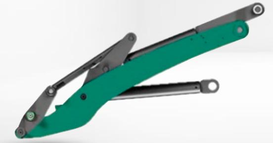
Le bras chargeur avec extension permet de répondre de manière encore plus flexible aux besoins spécifiques des clients. La portée, la charge utile et la hauteur de levage font partie des caractéristiques qui changent par rapport au bras chargeur standard.
