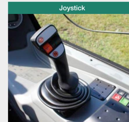
Le joystick ergonomique est solidement intégré dans l'accoudoir et permet un contrôle souple et précis de la machine. Pour plus de confort, la sélection du mode de vitesse est disponible directement sur le joystick. Ainsi il est possible de passer plus rapidement d'un niveau de vitesse à l'autre.
