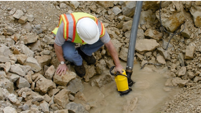
Tørløbssikre, elektriske dykpumper: selv ved uregelmæssig drift i længere perioder takket være den integrerede oliefordeler.
