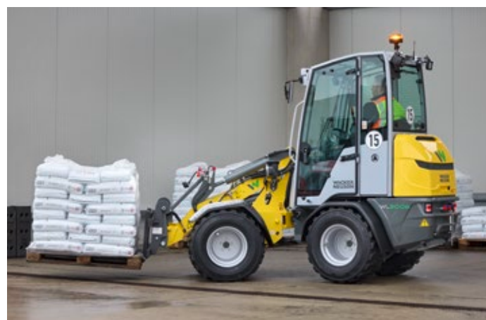
Spolehlivost i při manipulaci s těžkými náklady: šířkově nastavitelné paletové vidle.
