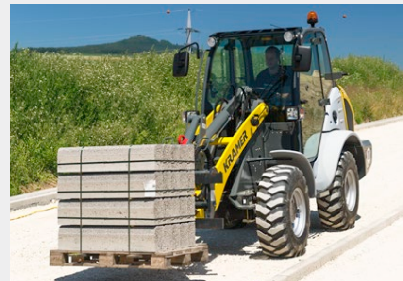
Řízení přední nápravy pro vyšší bezpečnost při rychlých přesunech
