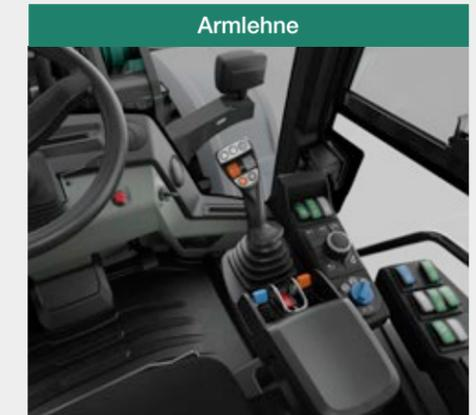
Die Armlehne, inkl. Joystick-Konsole und Jog Dial, ist am Fahrersitz montiert und mit den wichtigsten Bedienelementen ausgestattet. Somit kann die linke Hand am Lenkrad und die rechte Hand im Bereich der Armlehne bleiben. Die Armlehne ist hochklappbar und ermöglicht somit auch einen Ausstieg nach rechts.
