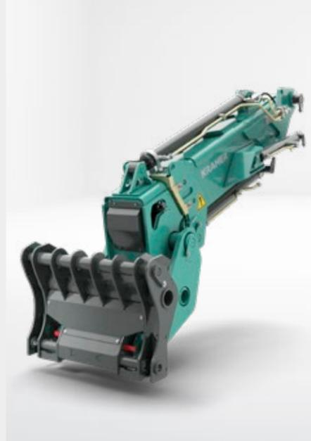
Die Z-Kinematik erweitert den vollwertigen Radlader um die Vorteile eines Teleskopradladers. Die teleskopierbare Ladeanlage ermöglicht eine größere Reichweite, sowie Schütthöhe. Dank der hohen Stapel-, Ausschütt- und Überladehöhe ist das Be- und Entladen von hochwandigen LKWs möglich.
