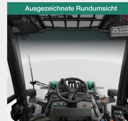
Große Glasflächen in Verbindung mit einem offen gestalteten Glasdach und der integrierten Rückfahrkamera bieten in der neuen Kabine eine ausgezeichnete Rundumsicht: einen hervorragenden Blick auf das Anbaugerät, den unmittelbaren Arbeitsbereich und die gesamte Maschinenumgebung.
