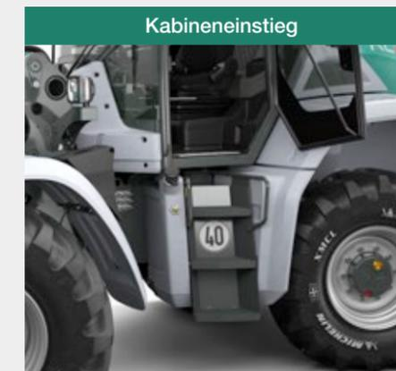
Die Fahrerkabine ist über die beidseitig, großzügig gestalteten Einstiegsbereiche über drei treppenförmige Stufen zu erreichen. Vier Haltegriffe (einer links an der A-Säule, zwei am Treppenaufstieg und einer an der Tür) ermöglichen einen sicheren Ein- und Ausstieg auf beiden Seiten. Auch eine Innenraumbeleuchtung mit Türkontaktschalter ist vorhanden.
