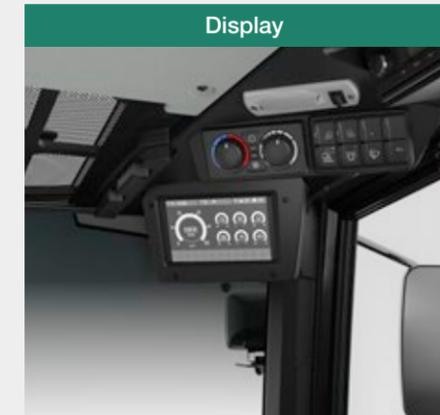
Die Maschinen sind mit einem völlig neuen Bedienkonzept, mit großem 7-Zoll LCD Display, ausgestattet. Der Aufbau des 7-Zoll Displays ist einfach und intuitiv gehalten. Alle wichtigen Fahrzeugdaten und Funktionen werden im Hauptmenü angezeigt. Die Helligkeit lässt sich regulieren und individuell Ihren Bedürfnissen anpassen.
