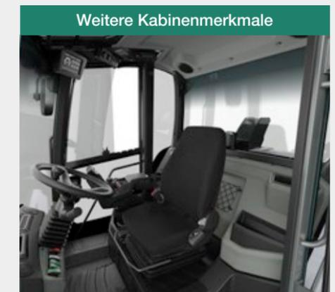
Durch das Kabinendesign wird der Fahrer vor Geräuschemissionen (70 dB(A)) geschützt. Außerdem können Klimaautomatik, Arbeitsscheinwerfer und Heckscheibenwischer seitlich oberhalb des 7-Zoll Displays gesteuert werden. Weitere Kabinenmerkmale sind: Bluetooth-Radio mit Freisprecheinrichtung, 12 V-Steckdose mit Schutzkappe, zwei USB-Anschlüsse uvm.
