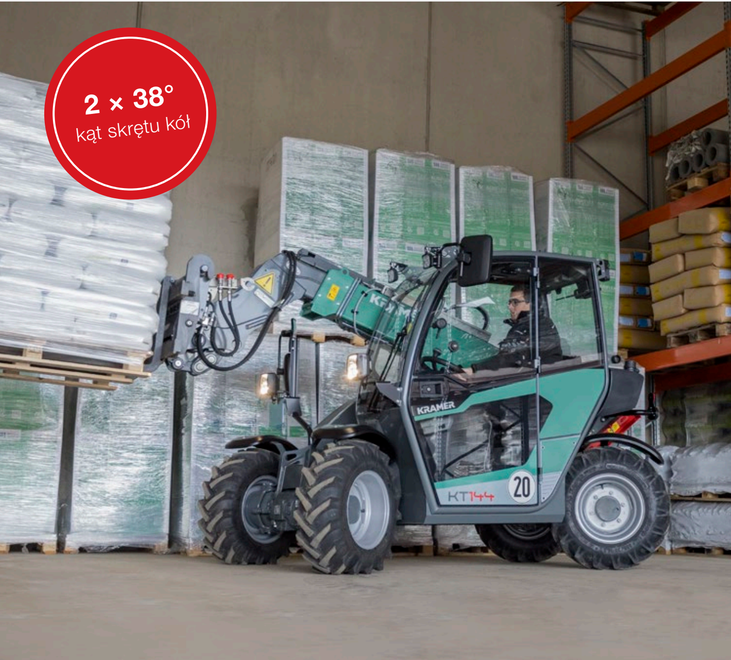
Tryb kierowania na wszystkie koła: szczególna zwrotność w wąskich przestrzeniach
