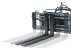
Widły do palet (regulowane hydraulicznie)
