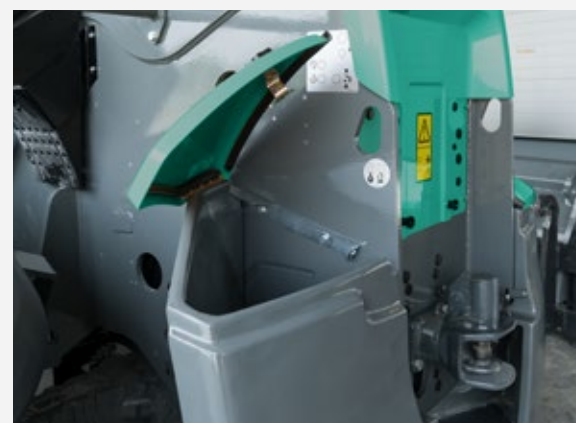
Schówek w obciążnikach tylnych w KT457 – KT559
