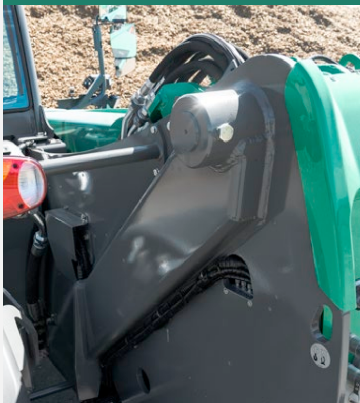
Wzmocnienie ramy przy sworzni głównym
