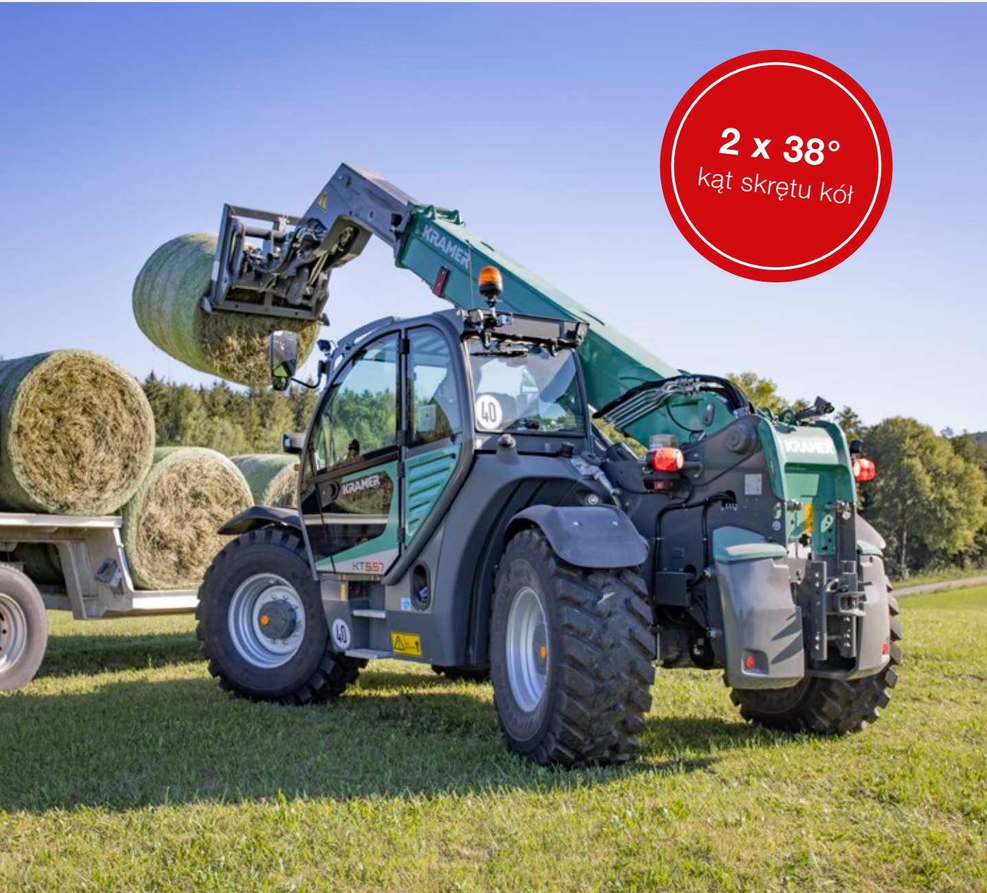
Tryb wszystkich kół skrętnych zapewnia maksymalną zwrotność
