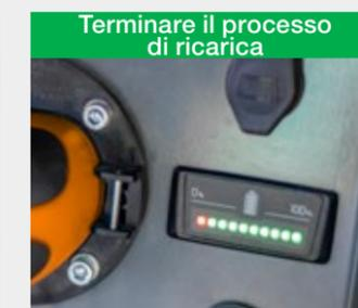
L'indicatore del livello di carica si accende in modo permanente non appena il processo di ricarica si conclude automaticamente.
