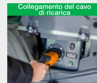
Aprire la console di ricarica e collegare il cavo di ricarica alla macchina.
