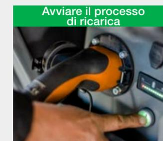
Azionare l'interruttore a pressione\* per avviare il processo di ricarica. L'indicatore del livello di carica nella parte posteriore della macchina inizia a lampeggiare.
