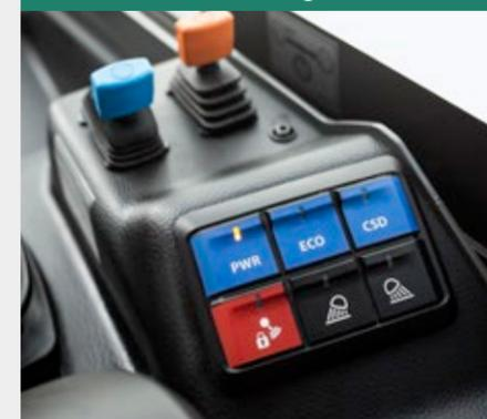
La caratteristica del modello KL14.5 include tre modalità di guida che possono essere modificate premendo un pulsante per soddisfare i rispettivi requisiti nel modo più efficiente possibile. La modalità Power (PWR) è adatta per lavori con la benna, la modalità ECO per lavori di accatastamento o marcia su strada e il dispositivo di modalità pedale dell'acceleratore (CSD) per attrezzi idraulici.
