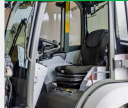
L'accesso alla cabina di guida è semplice e comodo grazie ad un'ampia zona di salita. Ciò include due ampi gradini disposti a forma di scala uno sopra l'altro. Inoltre, i gradini sono antiscivolo e proteggono l'operatore in tutte le condizioni atmosferiche. Le maniglie sono posizionate in una posizione facilmente accessibile e sono facili da impugnare.
