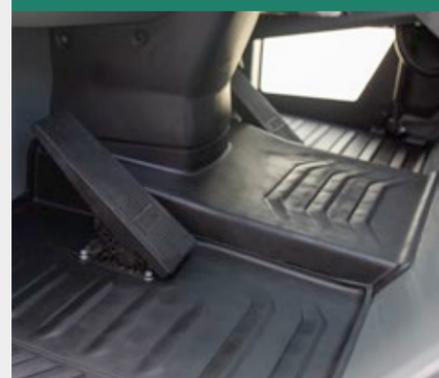
Il traforo centrale nel pavimento della cabina è alto solo 5 cm grazie al design del telaio del veicolo. Ciò consente la salita e la discesa comoda dell'operatore. Inoltre, il traforo centrale è ricoperto da un tappetino in gomma e può essere pulito facilmente.
