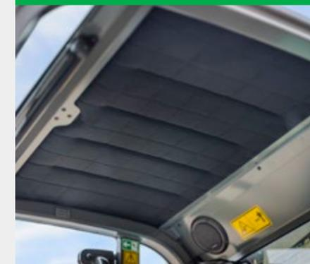
Oltre al riscaldamento ad aria, la cabina è dotata opzionalmente di riscaldamento del lunotto anteriore e posteriore a risparmio energetico, riscaldamento del sedile e riscaldamento superficiale. In altre parole, si riscaldano aree specifiche anziché l'intero volume d'aria. Il riscaldamento superficiale si trova nel tetto del veicolo e sotto il sedile dell'operatore. Inoltre, la cabina è ben isolata con tappetini isolanti in modo che il calore non vada disperso.
