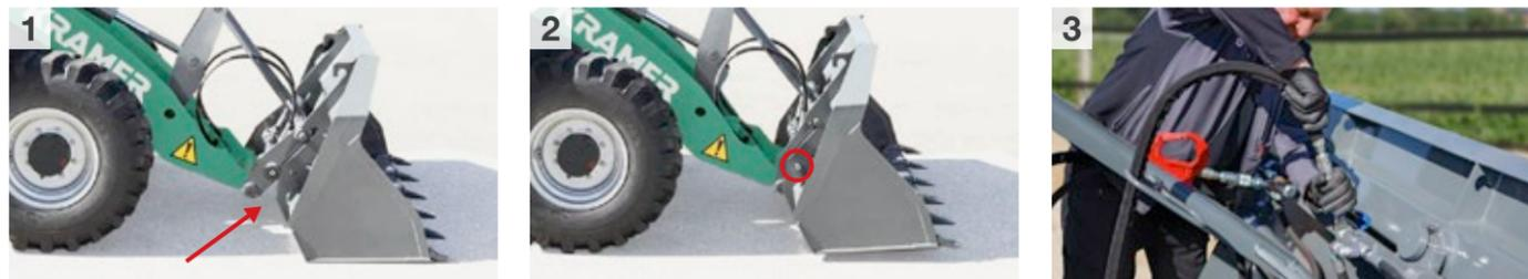
Il dispositivo di cambio rapido idraulico consente lo scambio facile degli attrezzi dalla cabina. La chiusura dei perni di bloccaggio avviene tramite il pulsante sul joystick. Per l'utilizzo di accessori con funzioni idrauliche aggiuntive, l'operatore deve uscire dal veicolo per l'accoppiamento manuale dei tubi.
