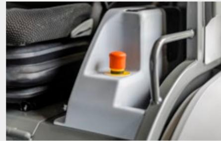
**Interruttore di arresto di emergenza rapidamente accessibile**, in modo che, in caso di pericolo, la macchina possa essere immediatamente messa in condizioni di sicurezza.
