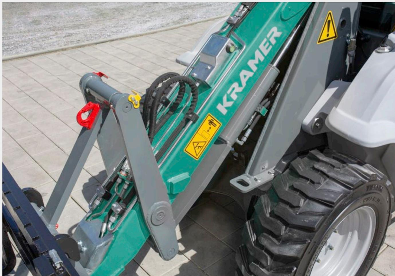
**Robusto sistema di carico** con cinematica Z, indicatore visivo di posizione e gancio di carico opzionale.
