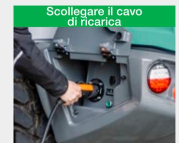
Azionare l'interruttore a pressione\* e rimuovere la presa di ricarica. Quindi, chiudere la console di ricarica e riporre il cavo di ricarica.
