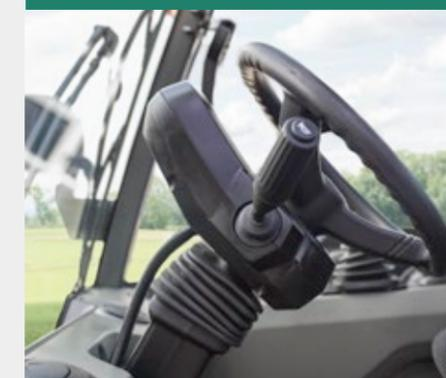
Il piantone dello sterzo opzionale regolabile in inclinazione può essere adattato alle esigenze dell'operatore. Il volante è realizzato con un materiale di alta qualità e antiscivolo. Inoltre, è disponibile anche un moderno display con ripristino automatico degli indicatori di direzione sul piantone dello sterzo.
