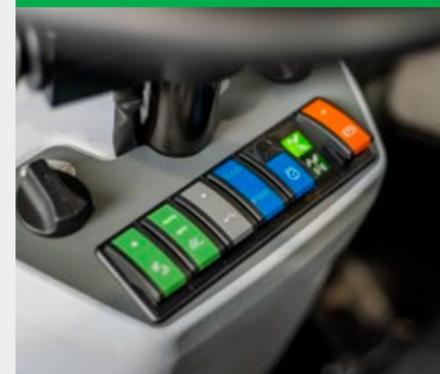
Le due modalità di guida, Eco e Power (PWR), possono essere decise con un interruttore a leva. Tra le altre cose, la modalità Eco consente di ridurre la velocità di guida fino a massimo 14 km/h. Ciò significa che l'operatore può risparmiare energia e guadagnare autonomia aggiuntiva. In modalità PWR, il veicolo funziona a piena potenza. La velocità massima di marcia è di 20 km/h.
