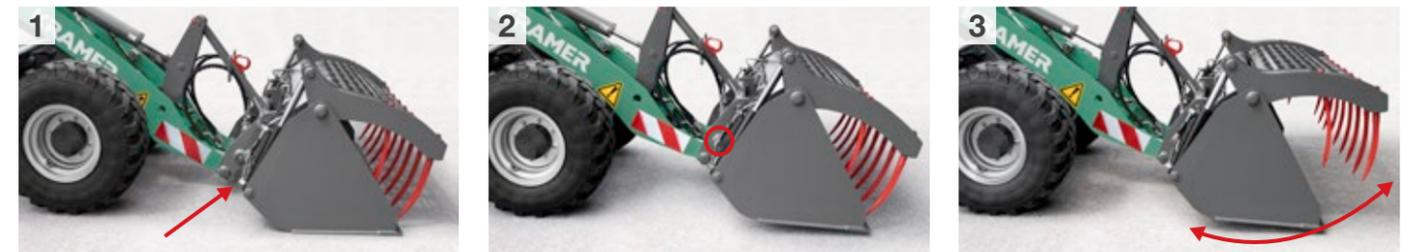
Smart Attach è un dispositivo di cambio rapido idraulico combinato con un sistema di aggancio automatico sviluppato sempre da Kramer. Il ricollegamento manuale dei tubi idraulici non è necessario e l'operatore non deve più scendere dalla macchina. Come di consueto, il comando avviene tramite il joystick direttamente dalla cabina.
