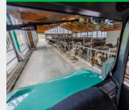
La cabina con una visuale chiara e il montante B collocato in maniera ottimale assicurano un'eccellente visibilità panoramica. Un parabrezza panoramico è integrato di serie. La copertura della batteria appiattita garantisce un'eccellente visuale posteriore. In più, è disponibile anche una pinna al centro del cofano per migliorare l'orientamento in retromarcia.
