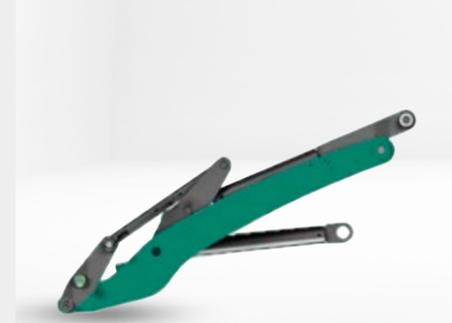
L'unità di carico a guida parallela assicura una forza di sollevamento costante e un uso sicuro durante la movimentazione di materiale. Con un angolo di inclinazione all'indietro fino a 45° e un angolo di scarico fino a 45°, la pala gommata non perde materiale nell'inserto della benna, anche con un livello di riempimento elevato
