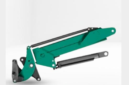
Il design compatto della scatola del sistema di caricamento telescopico rende la vista dell'attrezzatura unica. Vantaggi della cinematica Z: durante il carico della benna, con le stesse dimensioni dei cilindri si ottiene una forza di strappo maggiore in quanto il lato del pistone del cilindro idraulico viene sollecitato durante il carico.
