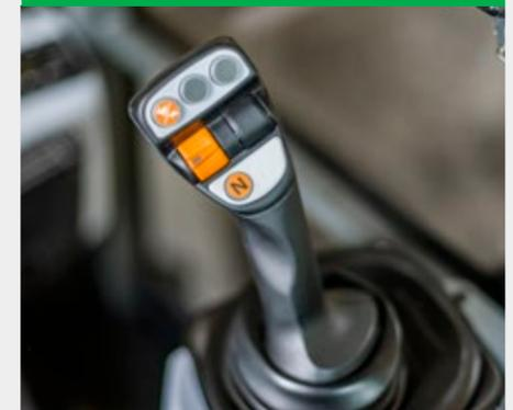
Il pulsante per le due marce è integrato sul joystick: tartaruga e lepre. L'operatore può regolare comodamente in qualsiasi momento la velocità massima di marcia. Ciò è possibile durante la guida. Il simbolo della marcia rispettiva viene visualizzato sul display. La velocità massima di marcia dipende anche dalla modalità di guida selezionata.
